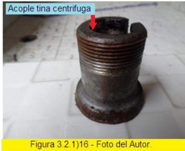
**3.2.1.17 Tuerca de ajuste tina centrífuga:** Es el componente que permite ajustar la tina centrífuga con el acople respectivo.
