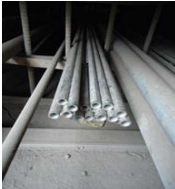
Figura 15 Tuberías de Acero diámetro 1/2", 40s
