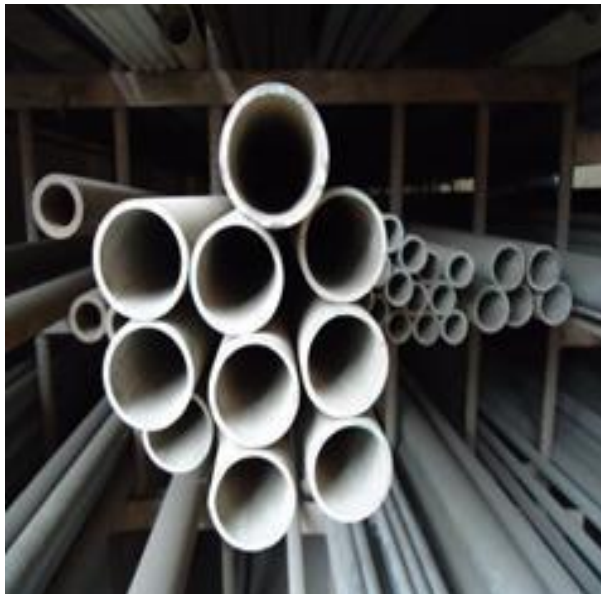
Figura 14 Tuberías de Acero diámetro 2", 40s
