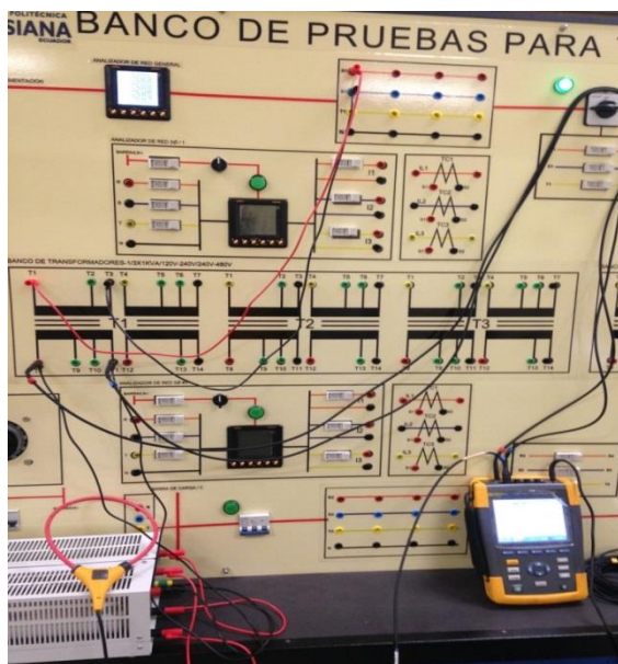
Figura 37. Tablero de ensayo del laboratorio, conectado el instrumento de medición en el lado primario y una carga resistiva en el lado secundario
