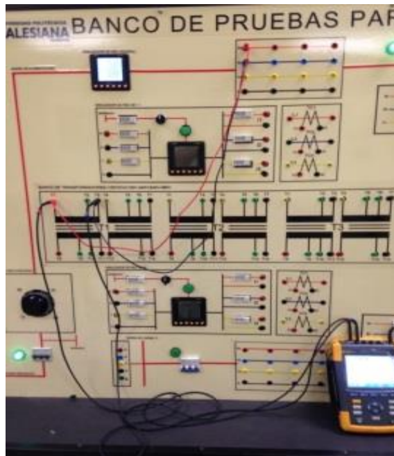
Figura 22. Tablero de ensayo en el laboratorio conectado el instrumento de medición para medir voltaje en el lado primario
