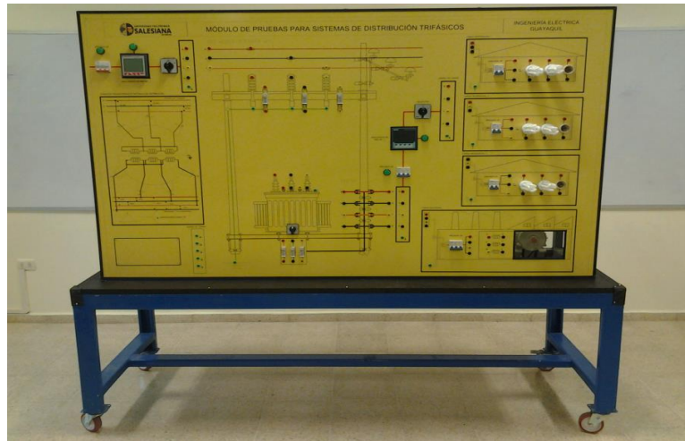
FIGURA 4. 1 Banco de pruebas para sistemas de distribución trifásicos.
