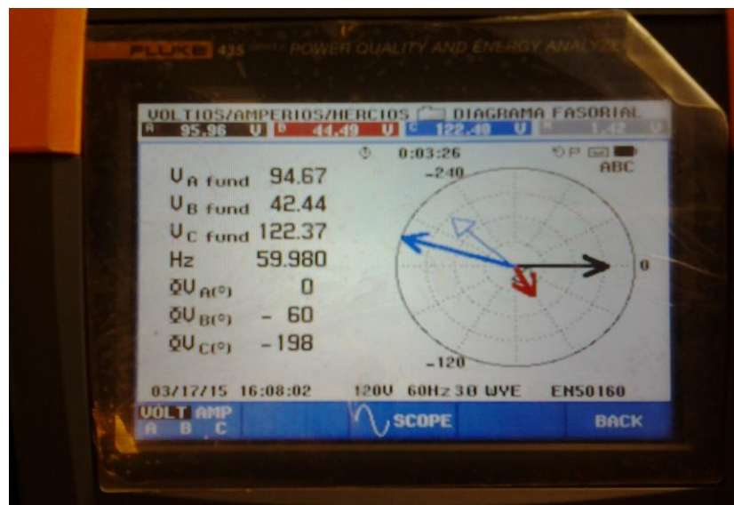
GRÁFICA 4. 8 Fasores de tensión en la red de baja tensión.
