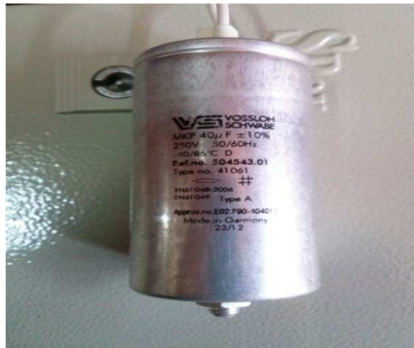
Figura 65 Capacitor de 40uF a 250VAC del banco de carga LC
