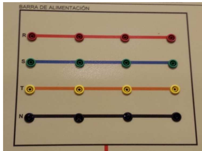
Figura 79 Barra de alimentación trifásica
