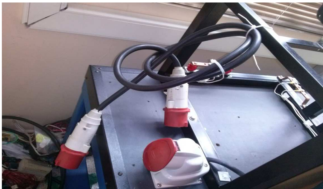
Figura 58 Conexión de cables de puesta a tierra e instalación de tomacorriente y cable de alimentación principal
