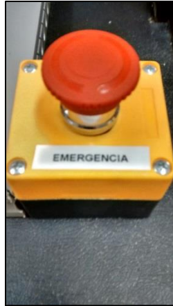
Figura 56 Pulsador de emergencia.
