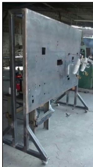
Figura 33 Estructura mecánica con la plancha soldada y sus respectivos agujeros
