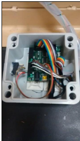
Figura 64 Tarjeta electrónica del cronómetro digital.
