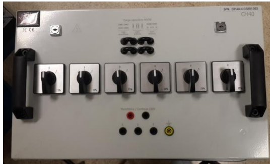
Figura 4.3: Banco de capacitores
