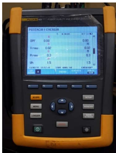
Figura 4.5: Analizador de red Fluke
