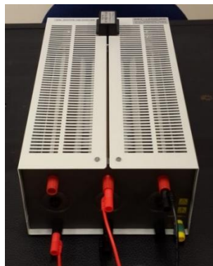
Figura 4.2: Banco de carga resistiva trifásica
