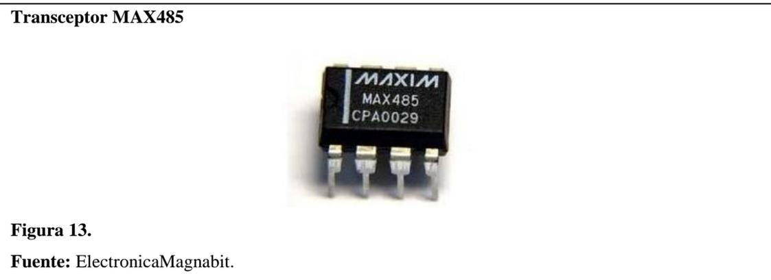
Estos transceptores permiten conectar hasta 32 microcontroladores en una red con una comunicación semidúplex, es decir que pueden enviarse señales en ambos sentidos, pero no simultáneamente.
