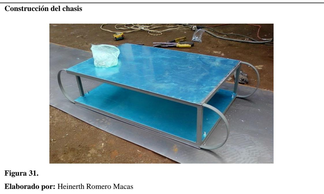
En la figura 31 se muestra el chasis construido y las tapas superior e inferior, las tapas son planchas de aluminio de 1mm de espesor.
