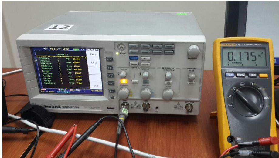
Figura 19. Medición de la corriente inicial con el multímetro y osciloscopio Elaborado por: Tatiana Osorio y Evelyn Puetate
