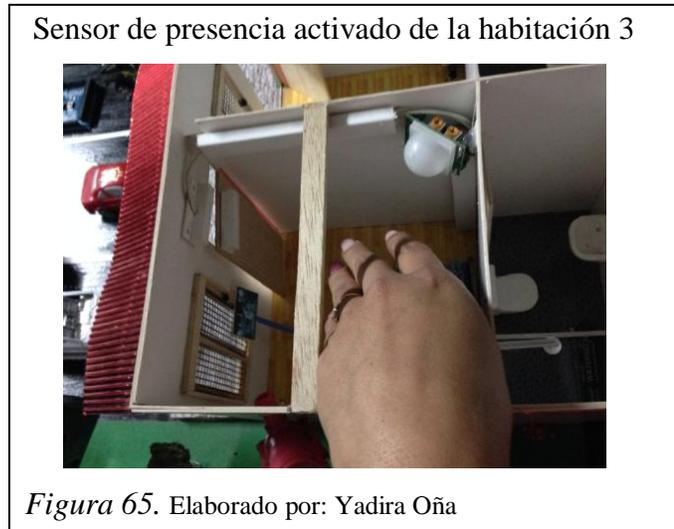
Al activarse el sensor de presencia, en seguida envía un mensaje de alerta al smartphone, como se muestra en la figura 66.
