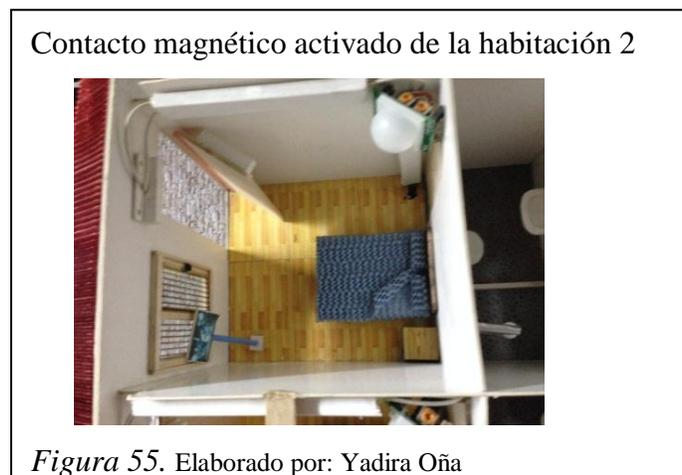
Al estar activa la alarma para la habitación 2 y detecta que existe una apertura de la puerta, automáticamente se envía un mensaje al Smartphone informando que se activado el sensor magnético de la habitación 2, como se muestra en la figura 56.
