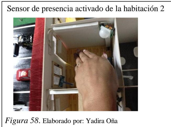
Al activarse el sensor de presencia, en seguida envía un mensaje de alerta al smartphone, como se muestra en la figura 59.
