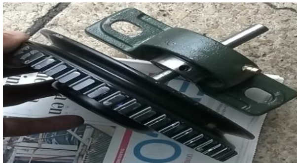
Figura 23. Acoplamiento mecánico entre la chumacera y la rueda dentada. Elaborado por: Oscar Moreno.
