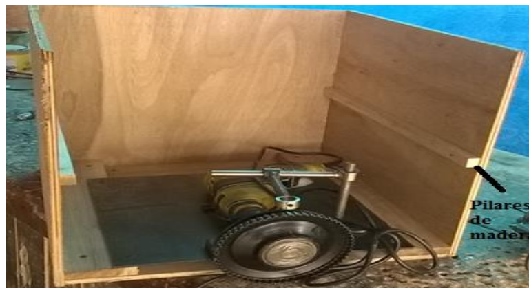
Figura 26. Colocación de las paredes laterales y posterior del módulo.
