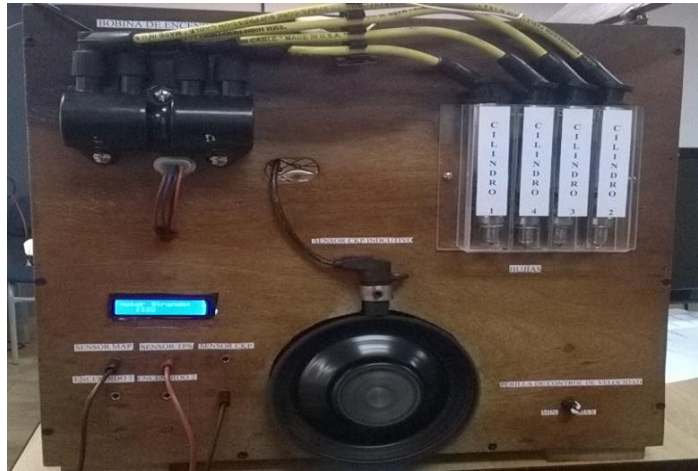
Figura 27. Distribución de elementos en la pared frontal del módulo. Elaborado por: Oscar Moreno.
