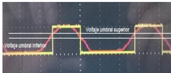
Figura 33. Comparación de la señal analógica de entrada con la señal digital cuadrada de salida. Elaborado por: Oscar Moreno 5 V DC/Div T=2.5 [ms]
