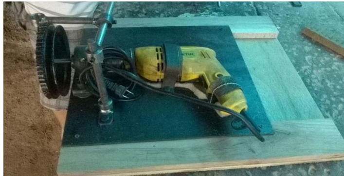
Figura 25. Base de madera que integra a la placa metálica con la estructura del módulo.
