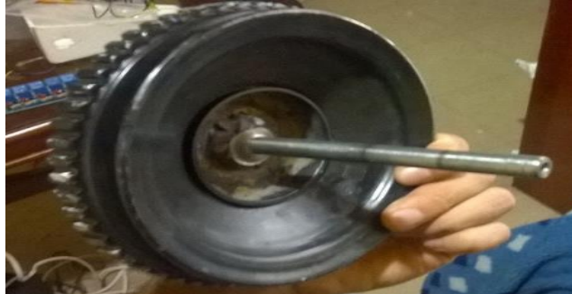
Figura 22. Acoplamiento mecánico de un eje a la rueda dentada. Elaborado por: Oscar Moreno.
