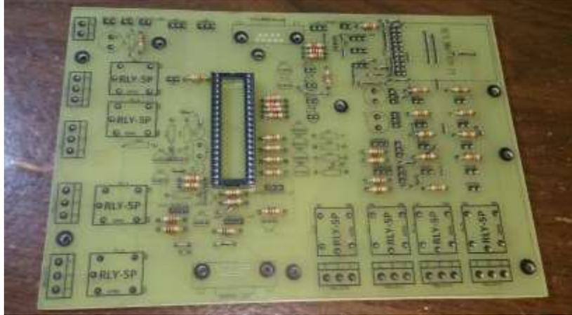
*Figura 50.* Vista del Screen de los elementos en la placa.
