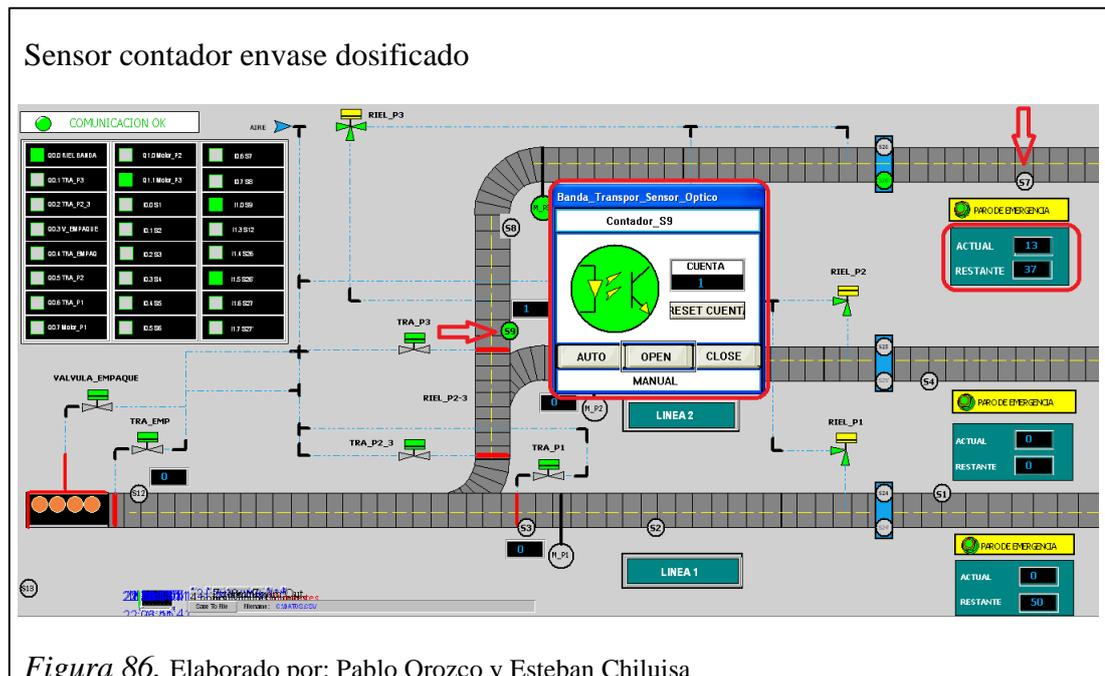
Cuando las señales de los sensores S8 y S9 se encuentren activas, aparecerán los 8 tarros listos a ser transportados a la línea de despacho mediante la apertura del pistón que controla el tráfico de la línea (tra\_P3). Figura 87.
