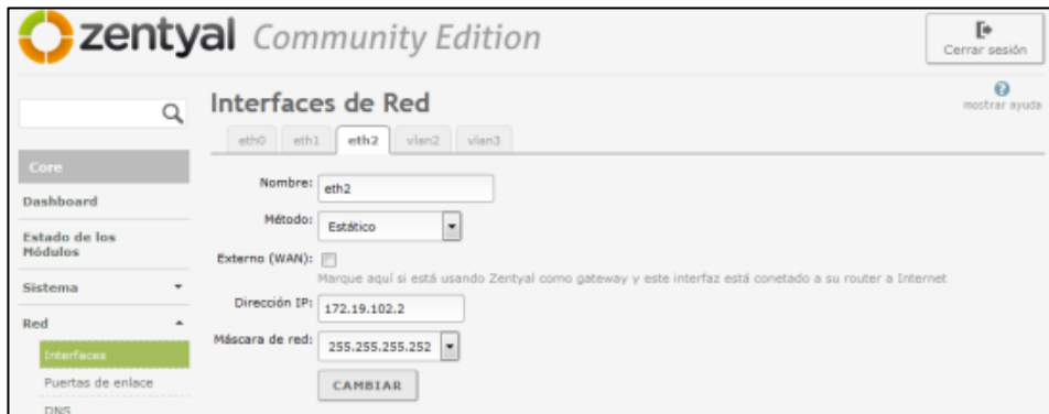
Configuración de RED de la eth2 para enlace de datos con los distritos y MINEDUC.
