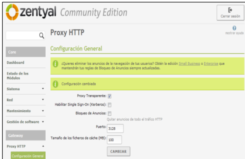
Configuración como proxy transparente para salida a internet en ZENTYAL.
