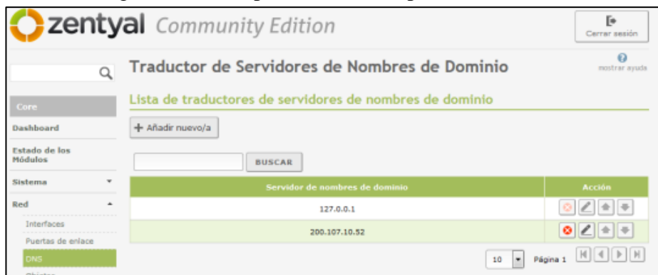
Configuración de los DNS para salida a internet.
