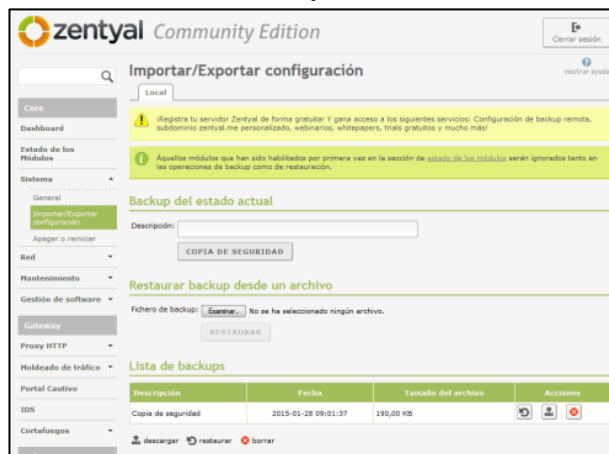
Generación de Back-UP de la configuración actual de ZENTYAL.
