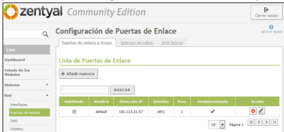
Configuración de la puerta de enlace para salida a internet.
