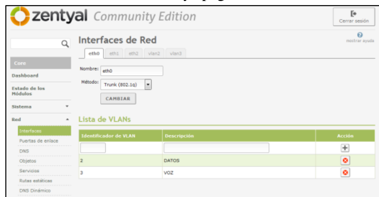
Configuración de RED de la eth0 para LAN del Distrito.
