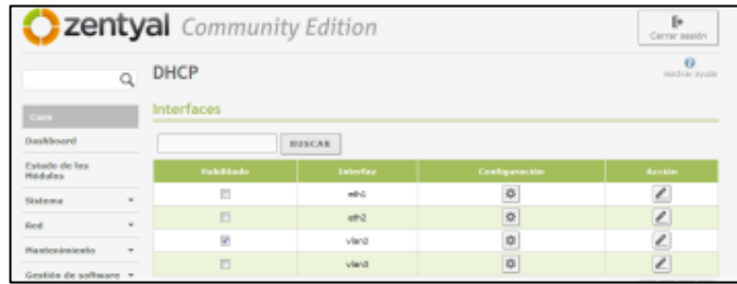
Módulo de DHCP activado para la VLAN 2 DATOS.
