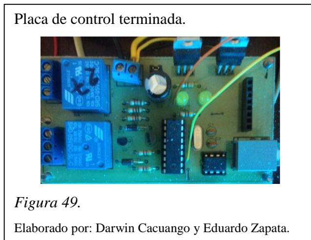
En la figura 49, se observa la placa terminada con todos sus componentes y lista para el montaje en el prototipo.
