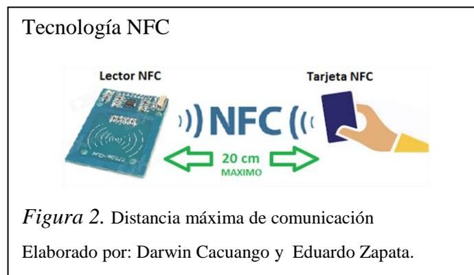
Cualquier tipo de dispositivo NFC dentro del estándar ISO/IEC 14443 puede establecer una comunicación para el intercambio de datos e información. NFC fue creada principalmente para el uso en teléfonos móviles, tarjetas inteligentes ya que no se transmite datos masivamente (INTECO, 2013).
