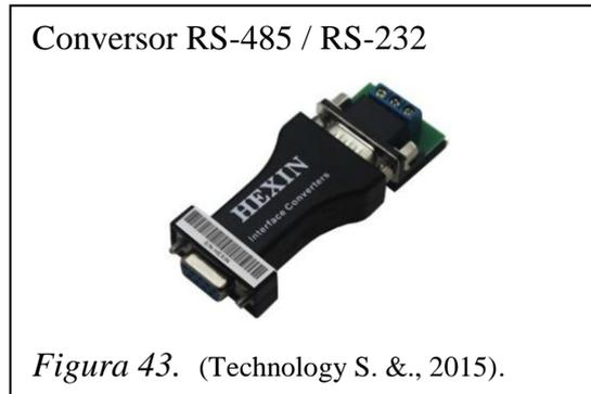
En la figura 43, se muestra el Convertidor HXSP-485 es un convertidor bidireccional entre RS-232 y RS-485; se utiliza principalmente para la comunicación entre controladores principales y periféricos, logra la comunicación de solicitud-respuesta entre múltiples máquinas.
