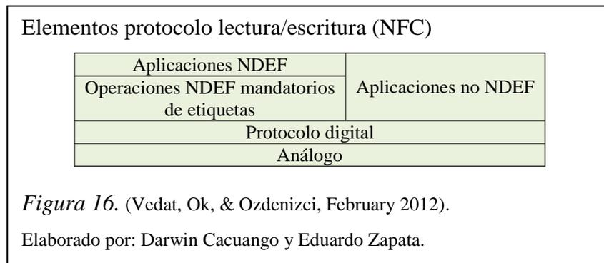
La figura 16, muestra la estructura de elementos de protocolos de un dispositivo NFC que se encuentre operando en modo lectura/escritura, se observa que NFC utiliza protocolos análogos y digitales en la capa inferior, donde el protocolo análogo determina el rango de radio frecuencia operable de los dispositivos NFC. Los protocolos digitales refieren a los aspectos digitales de la comunicación NFC debidamente establecidas en los estándares ISO/IEC 18092, 14443 (Forum, 2004).
