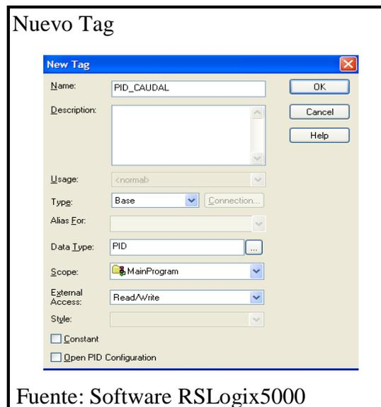
Una vez creado el tag, se originan automáticamente los tag propios del bloque de función PID
