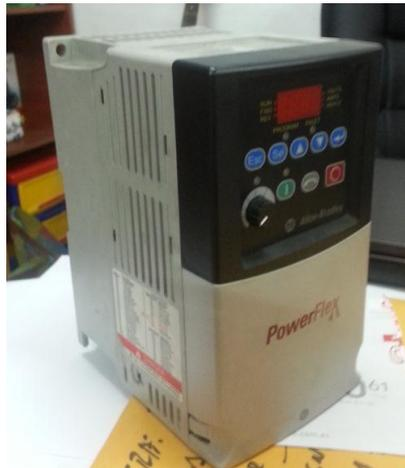
*Figura 9.* Variador de frecuencia usado en el proyecto
