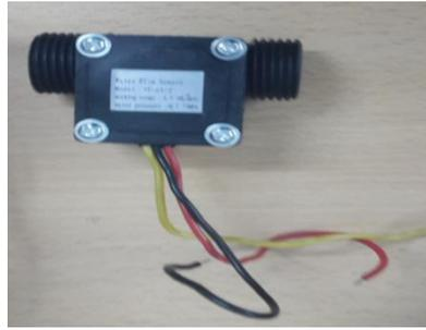
*Figura 8.* Sensor de flujo usado en el proyecto
