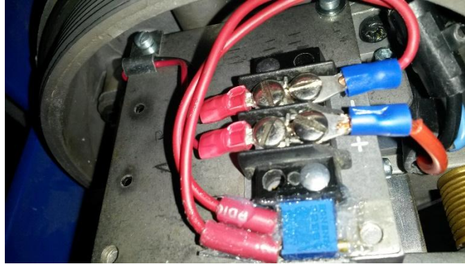
Figura 61. Conexión de potenciómetro al transductor electro-neumático Fisher Elaborado por: Amaya Danilo y
