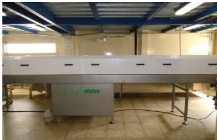
Ilustración 4.17. Túnel de frío visto de manera frontal
