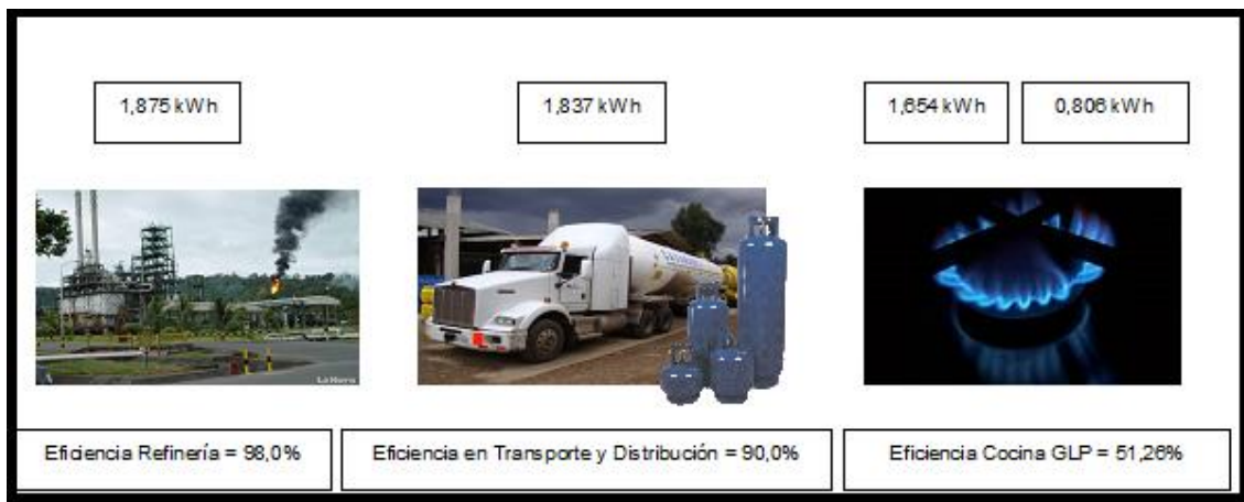
Figura 17. Cadena de eficiencia mediante la cocción con gas licuado de petróleo. Elaborado por: Wendy Jácome, Andrea Rojas
