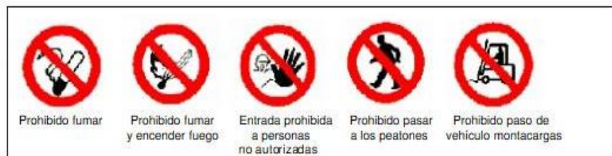
Fig.3. Señales de prohibición (peligro)
