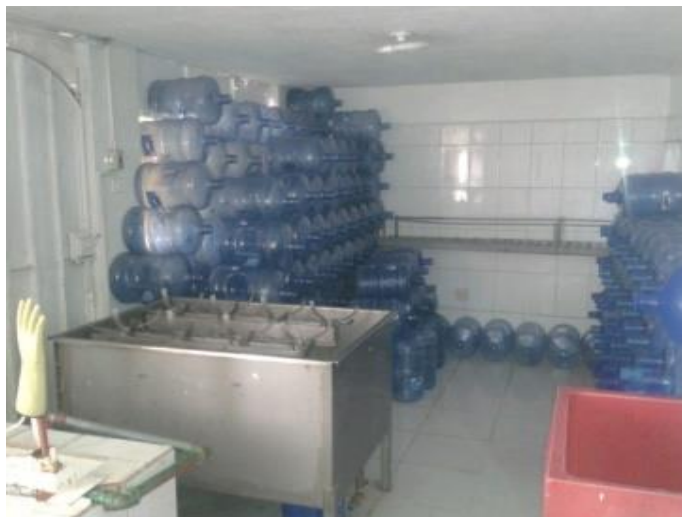
Figura 8: Área de lavado y desinfección de botellones Aguantisana Elaborado por: Rodríguez & Segovia.
