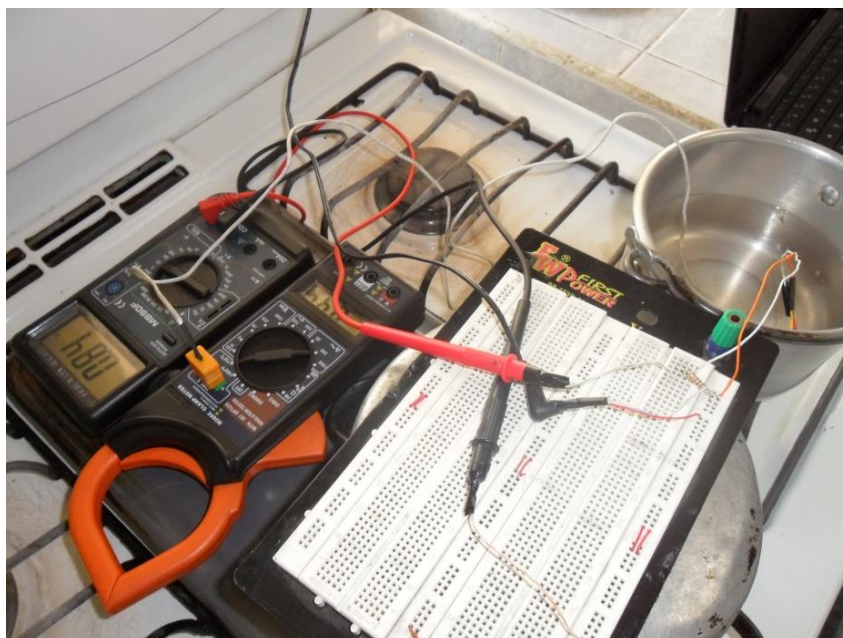
Figura 3. 5 (Medición NTC de agua de refrigeración)
