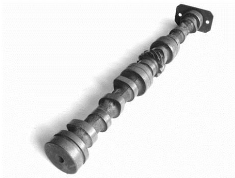
Figura 1. 7 Árbol de levas ( http://www.emc.uji.es/ )
