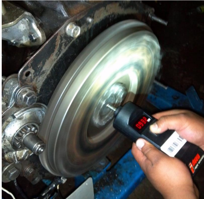
Figura 3. 20 (Medición de rpm en el motor)
