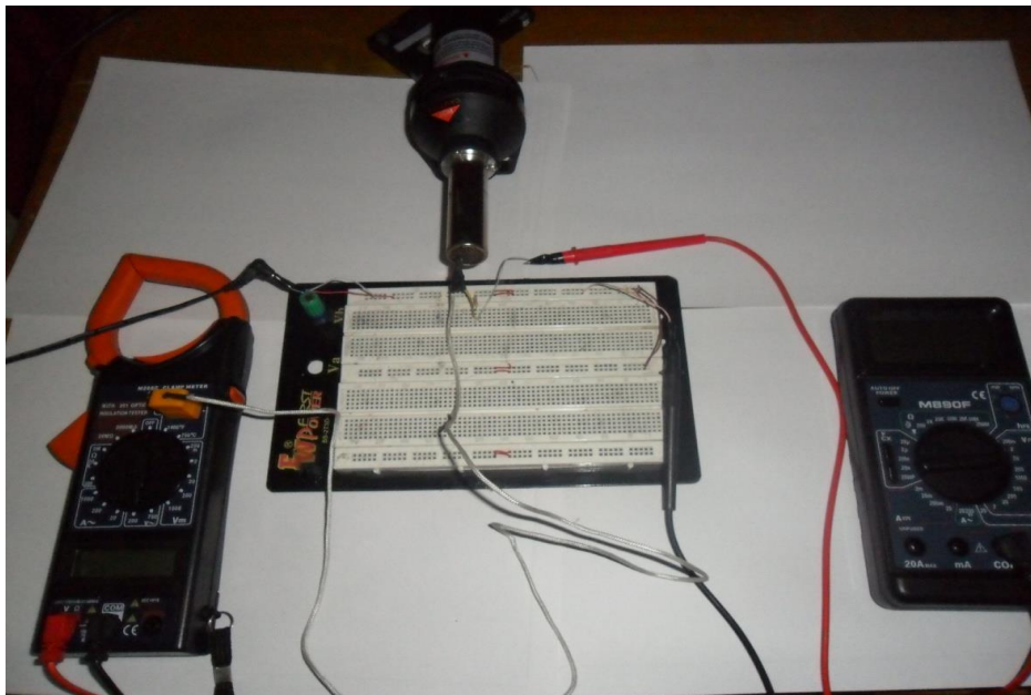
Figura 3. 10 (Medición NTC de gases de escape)
