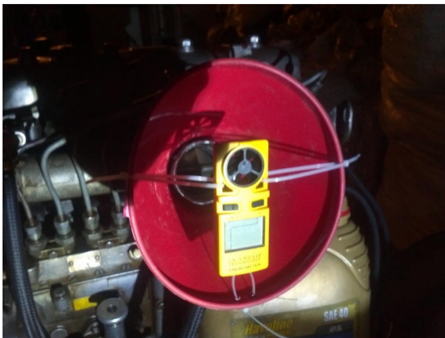
Figura 3. 19 (Montaje del anenómetro para las pruebas)
