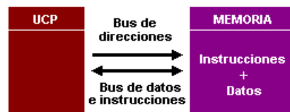
Figura 2.2.2: Gráfico de explicación arquitectura Von Neumann Fuente:Rueda Luis, “Ero-Pic”; http://perso.wanadoo.es/luis_ju/pic/pic03.html
