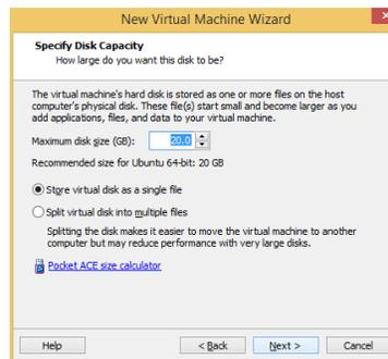
Fig. 63. Característica de Capacidad de la máquina virtual. Fuente (Autores)
