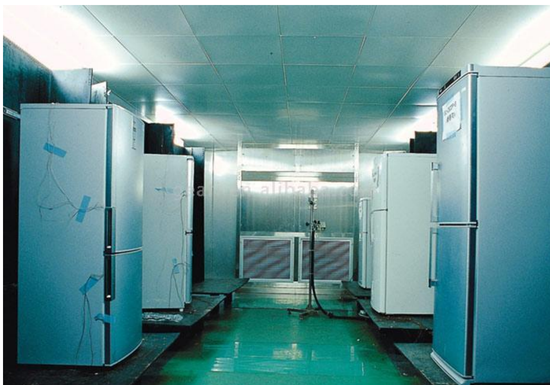
Figura 2.19. Cámara de ensayo para refrigeradores de uso doméstico.
