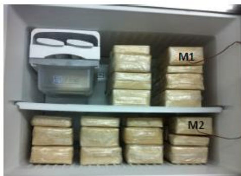
Figura 2.20. Carga de paquetes M en un compartimiento de congelamiento de un refrigerador de uso doméstico.
