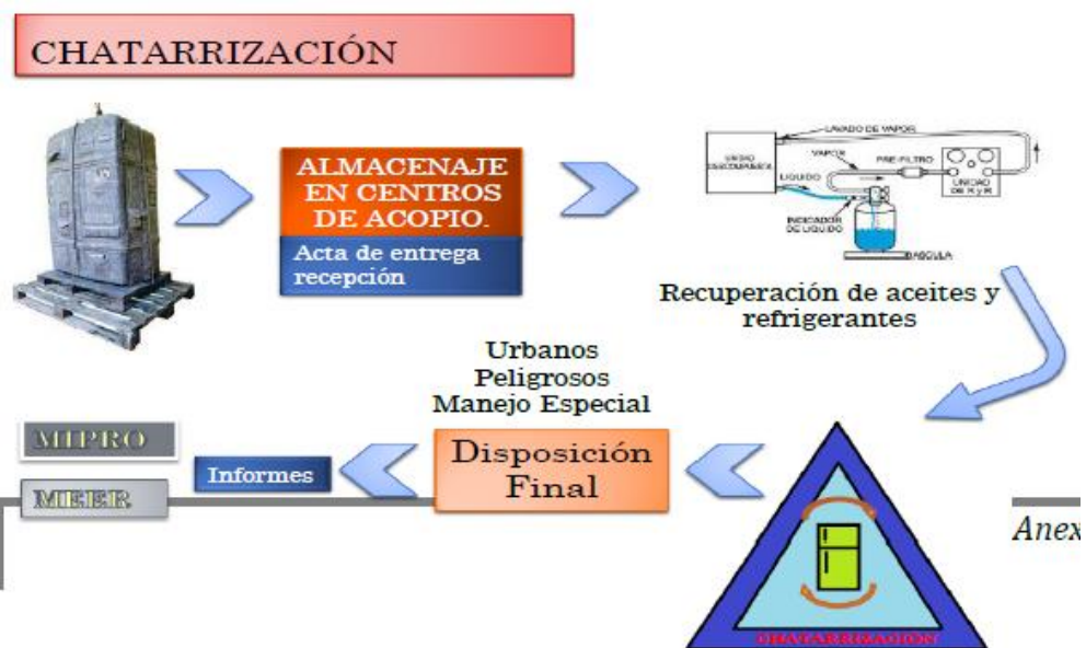
Figura 3.6 . Proceso de Chatarrización de refrigeradores canjeados. Fuente: (Ministerio de Electricidad y Energía Renovable (MEER), 2014)
