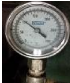
Figura 11: Manómetro con sifón tipo R
