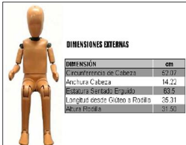
Figura 3. 2: Dimensiones del Hybrid III, Q6 niño.
