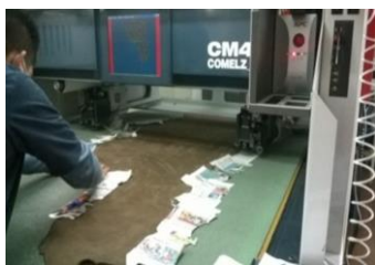
Figura 3. Maquinaria de corte y grabado sirve para realizar los cortes del cuero en piezas pequeñas dependiendo del modelo que se va a fabricar.
