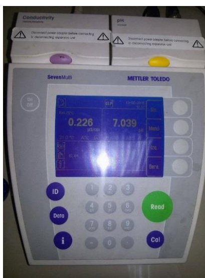
Foto 32. Análisis del pH y CE del agua utilizado en el Ensayo.
