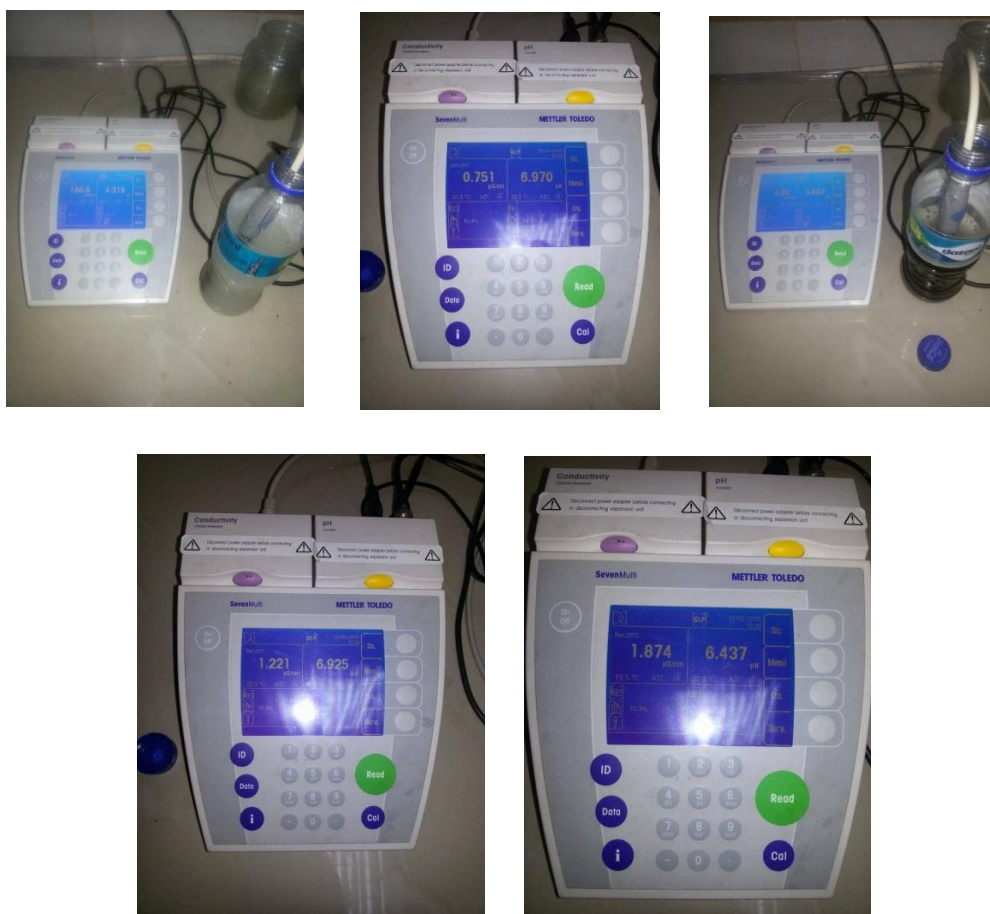
Foto 31 Análisis de pH y CE, de las muestras de los tratamientos.
