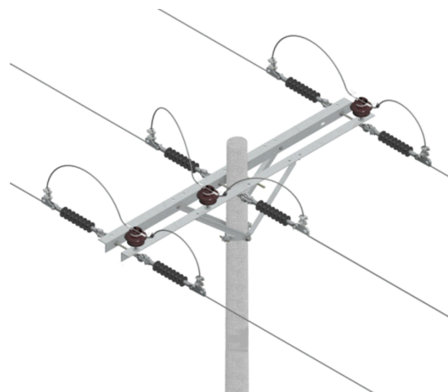
Figura 1, 5 Estructura de Distribución de red primaria aérea 6
