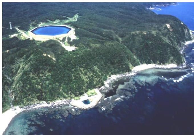
Figura 1.4. Esquema de una CHAB con agua de mar.
