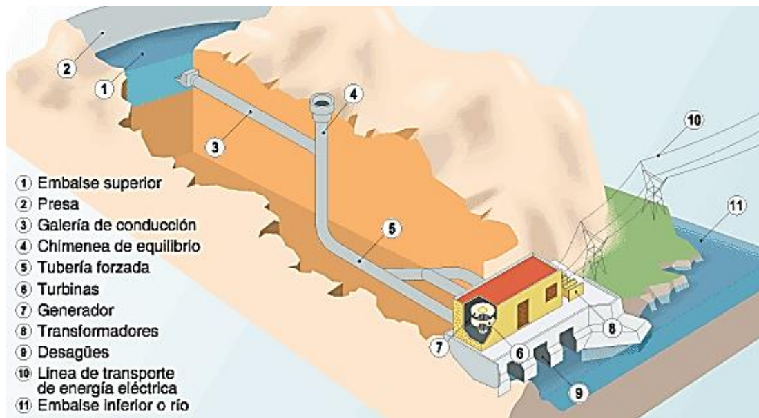
Figura 1.11. Partes de una central hidroeléctrica reversible.
