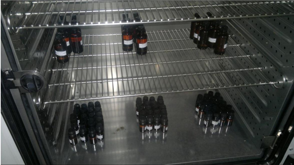
Figura 9.- Cámara de estabilidad acelera 40°C y 75% HR.
