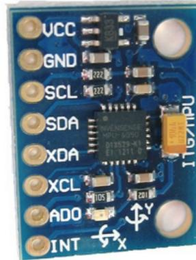
Figura 2.3: Sensor MPU 6050[20].
