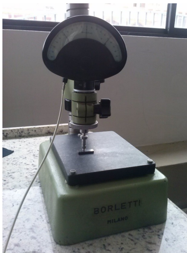
Figura 3.21 – Milisímometro Borletti para la medición del alabeo.
