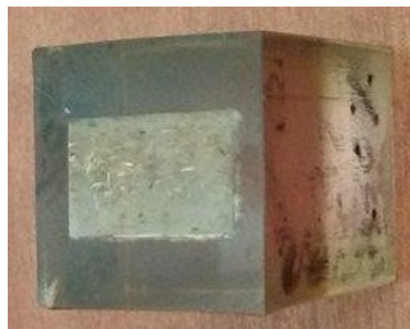
Figura 3.31 – Embebido de la probeta [87].
