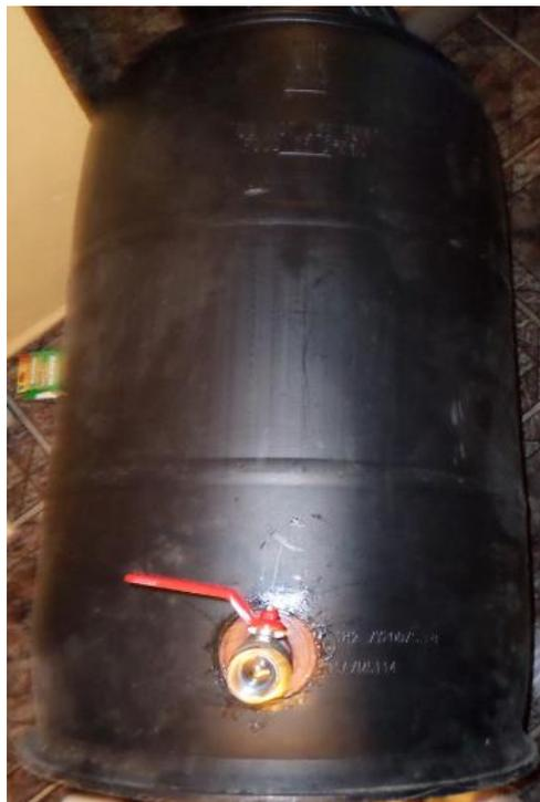
Figura 33: Llave de salida de lodos
