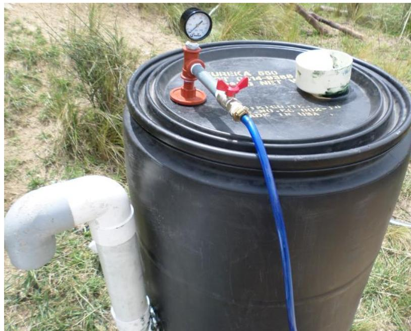
Figura 37: Salida de biogás y Manómetro
