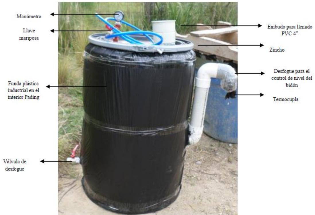
Figura 41: Partes del biodigestor
