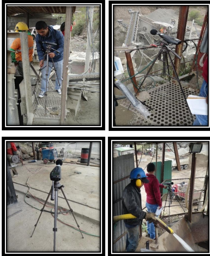
Ilustración 42. Toma de Mediciones de Ruido. Fuente: Los Autores.
