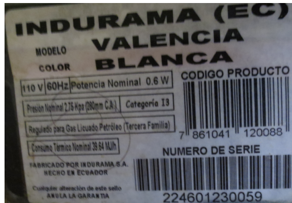
Figura 1.23: Características cocina a gas analizada de modelo Valencia; marca Indurama.
