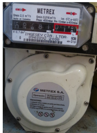
Figura 1.24: Gasómetro utilizado en la prueba; marca Metrex.
