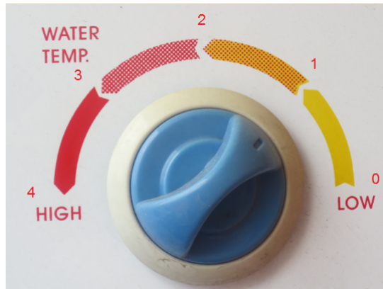
Figura 1.33: Selección de temperatura en el calefón analizado.
