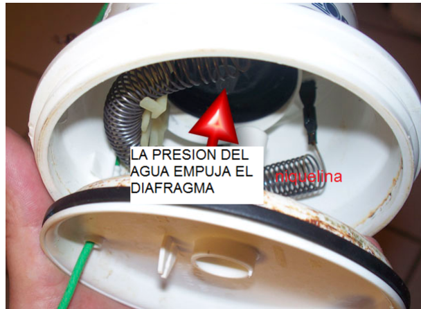
Figura 1.35: Mecanismo de activación diafragma de ducha eléctrica.[28]
