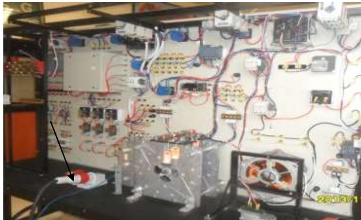
**Figura 8:** Alimentación principal 220VAC con voltaje fijo
