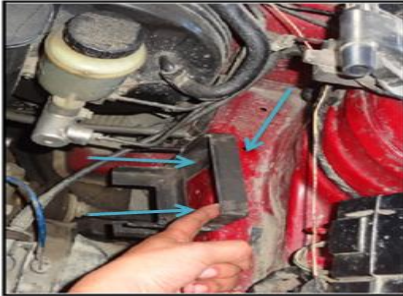
Fig.3.28– Fijación de la jaula en el chasis Fuente: Los autores
