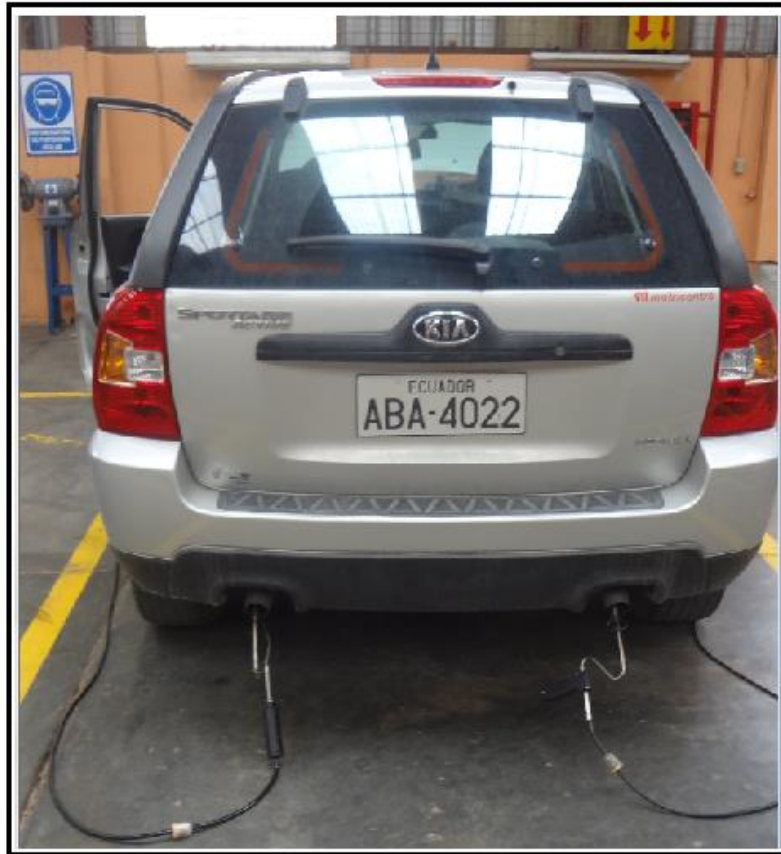
Fig.4.5– Sonda en el tubo de escape Fuente: Los autores
