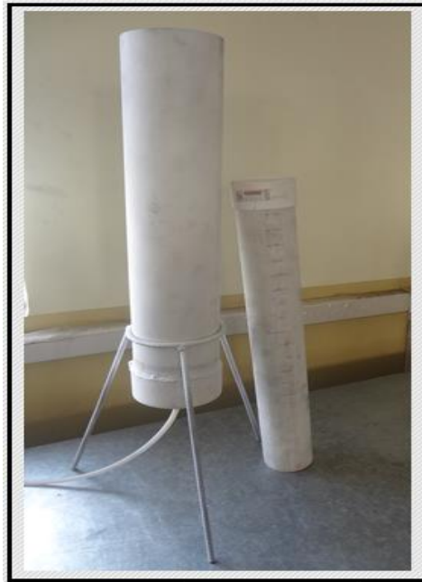
Fig. 3.13– Construcción del caudalímetro Fuente: Los autores
