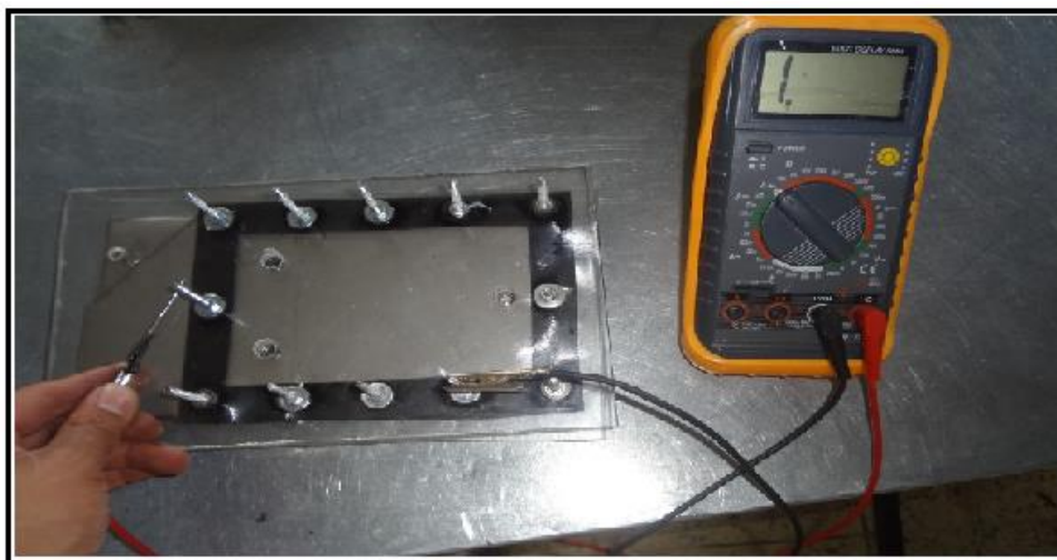
Fig. 3.24– Verificación que no haya continuidad en los electrodos y tornillos Fuente: Los autores
