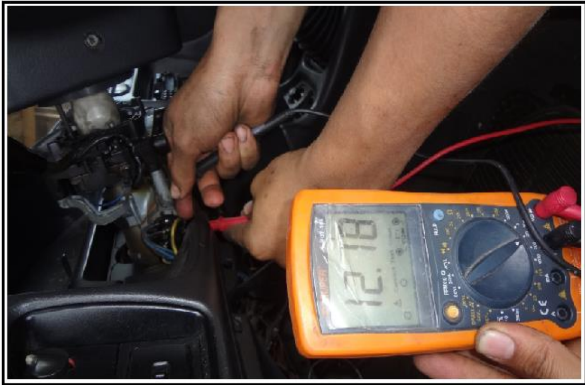
Fig.3.32– Búsqueda de cable de 12,18v para alimentar al circuito Fuente: Los autores
