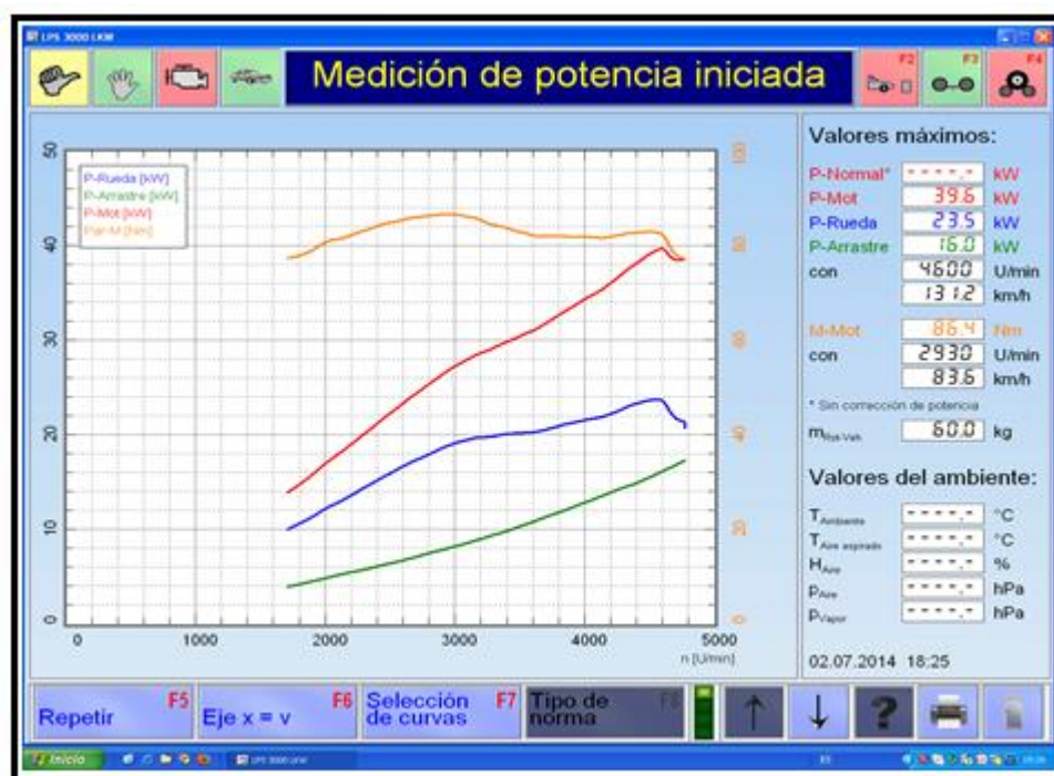
Fig. 2.2 Curvas de potencia y par Fuente: U. P. Salesiana, «Banco dinamométrico,» Cuenca, 2014.
