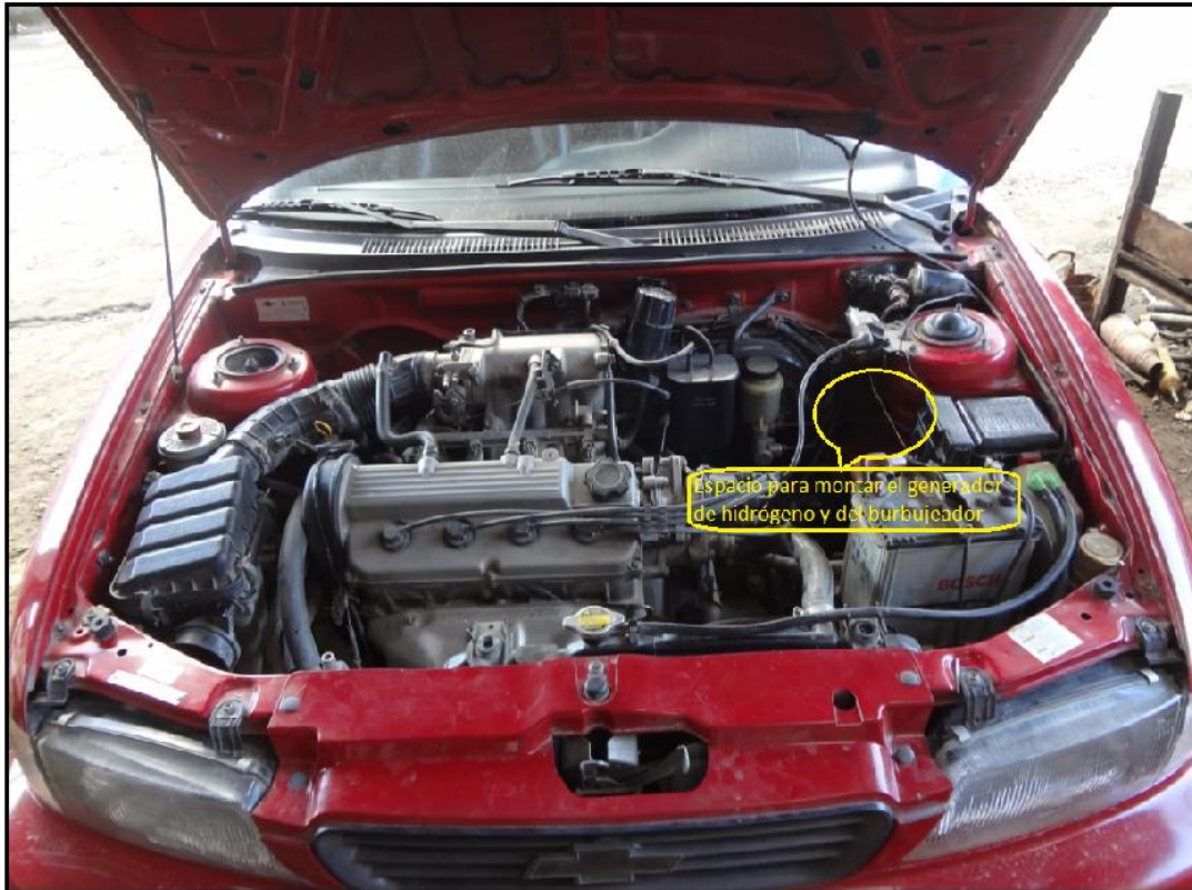
Fig. 3.27– Espacio para montar el generador y el burbujeador Fuente: Los autores
