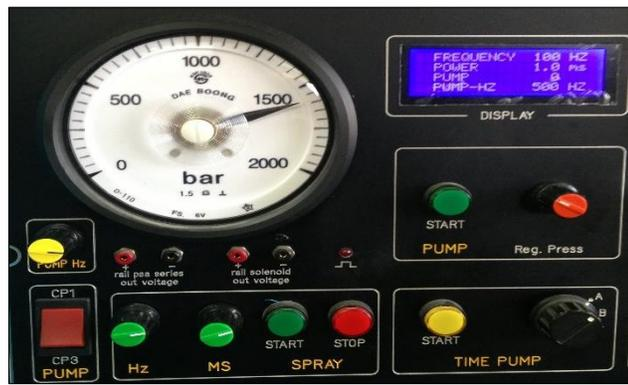
Figura 3.6 Calibración de la válvula de sobrepresión 2. Fuente: Autores.
