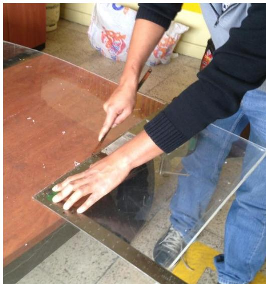
Figura 2.46 Corte de la lámina de acrílico. Fuente: Autores.
