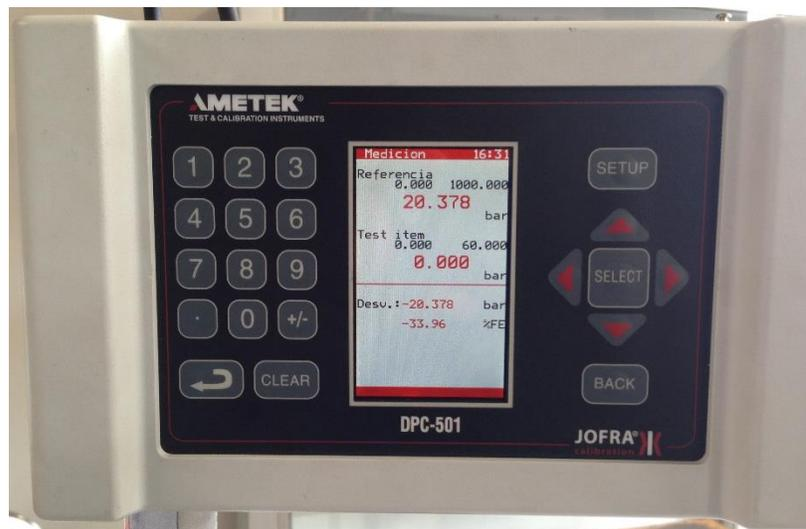
**Figura 3.3** Medición con el equipo de calibración de presión. **Fuente:** Autores.
