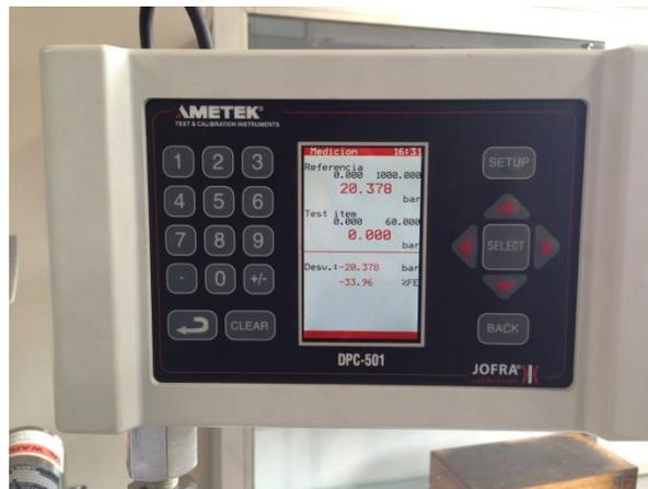
**Figura 3.1** Equipo de calibración de presión. **Fuente:** Autores
