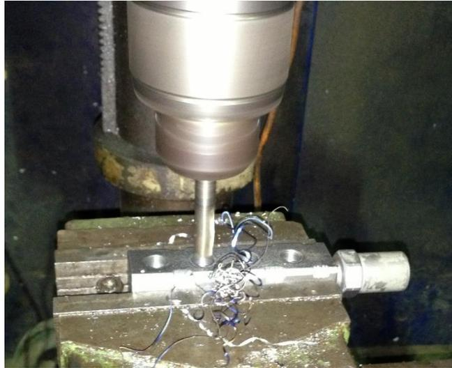
**Figura 2.26** Mecanizado del riel 2. **Fuente:** Autores.
