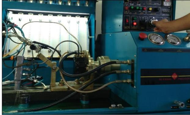
Figura 3.5 Calibración de la válvula de sobrepresión 1. Fuente: Autores.
