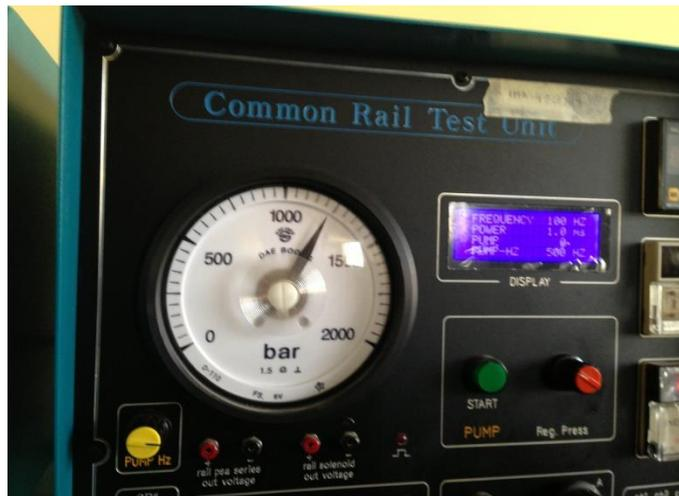
**Figura 2.37** Manómetro de presión banco Common Rail. **Fuente:** Autores.
