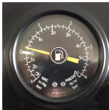
**Figura 3.24** Manómetro de presión de alimentación. **Fuente:** Autores.
