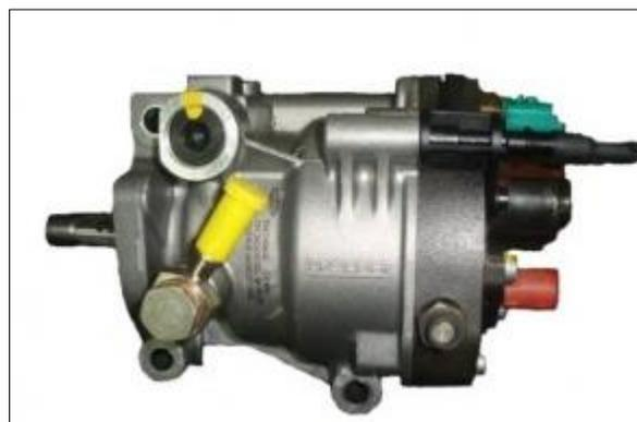
**Figura 1.27** Bomba Common Rail Delphi. Fuente: [12]
