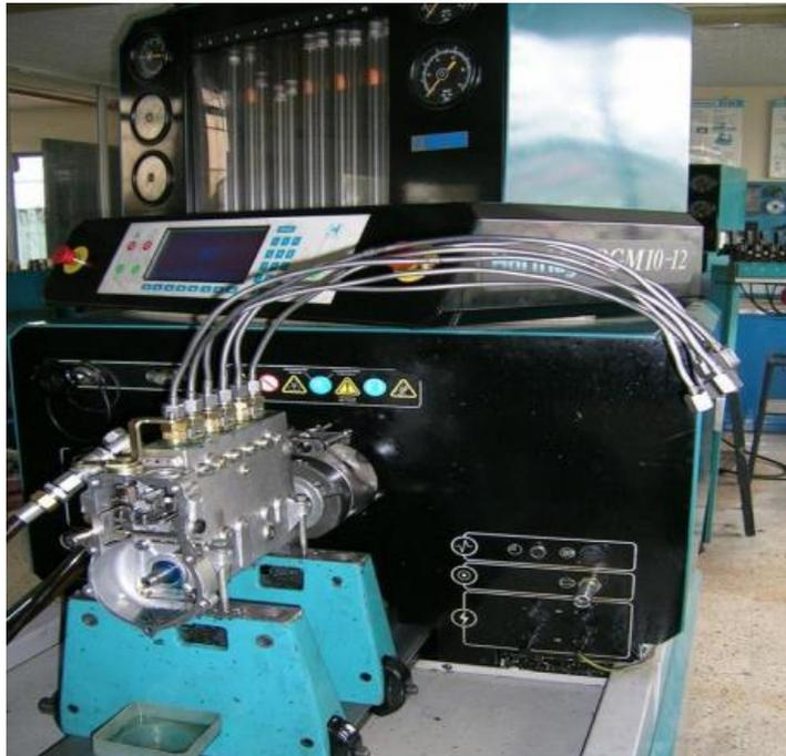
Figura 1.38 Banco de pruebas Hartridge PGM 10-12. Fuente: [15]
