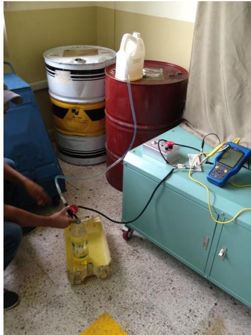
**Figura 2.39** Ensayo de comprobación de caudal. **Fuente:** Autores.
