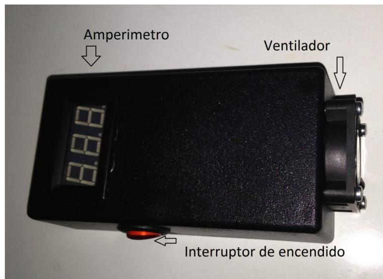
**Figura 2.30** Vista externa caja de circuito de potencia. **Fuente:** Autores.
