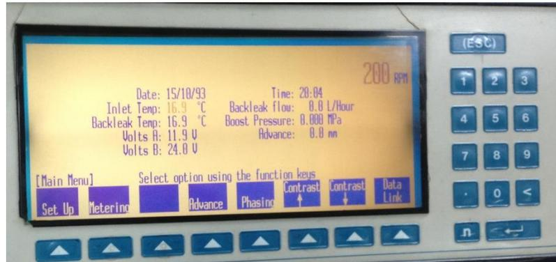
Figura 3.31 Panel de control del banco de pruebas. Fuente: Autores.
