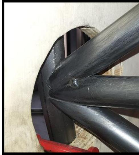
**Figura 4. 10.** Acople de los tubos cortados.
