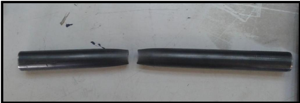
**Figura 1. 41.** Probeta de tubo de acero de un material dúctil.
