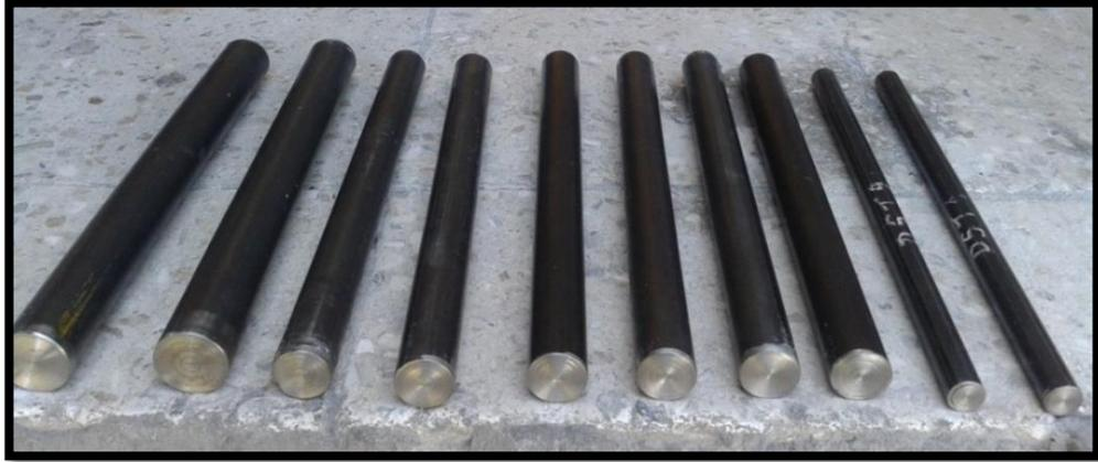
**Figura 1. 40.** Probetas de tubo de acero, con bujes de acero.
