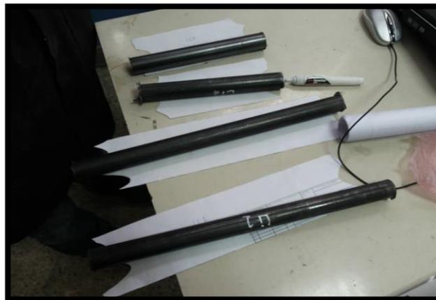
**Figura 4. 8.** Marcado del contorno del corte.
