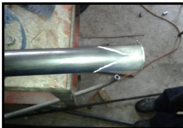
**Figura 4. 9.** Marcado del contorno del corte.
