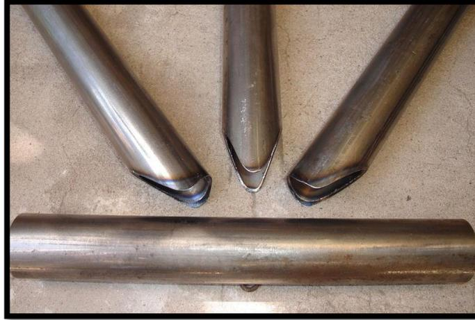
**Figura 4. 3.** Corte tipo boca de pescado.
