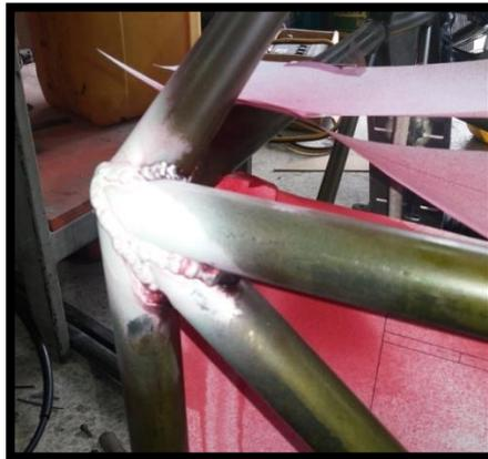
**Figura 4. 30.** Aplicación del líquido revelador.
