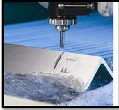
**Figura 4. 4.** Corte de un perfil por chorro de agua.
