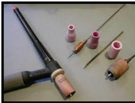
**Figura 4. 20.** Boquilla para soldadura TIG
