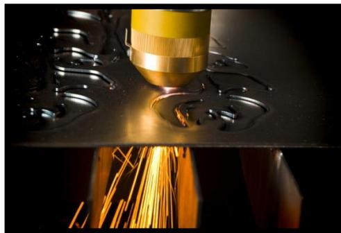
**Figura 4. 5.** Corte de chapa metálica por plasma.
