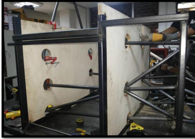
**Figura 4. 19.** Colocación de tubos desde el arco frontal al arco principal.
