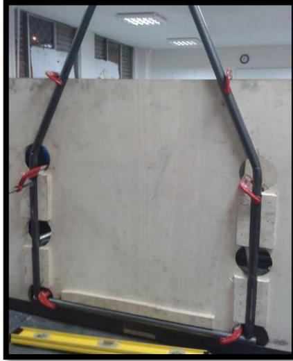
**Figura 4. 17.** Arco principal doblado y sujetado a la mesa.
