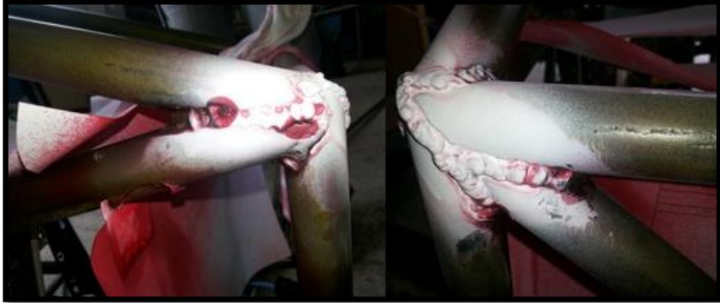
**Figura 4. 31.** Revelado de las imperfecciones.
