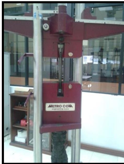
**Figura 1. 39.** Maquina universal para ensayos de materiales.
