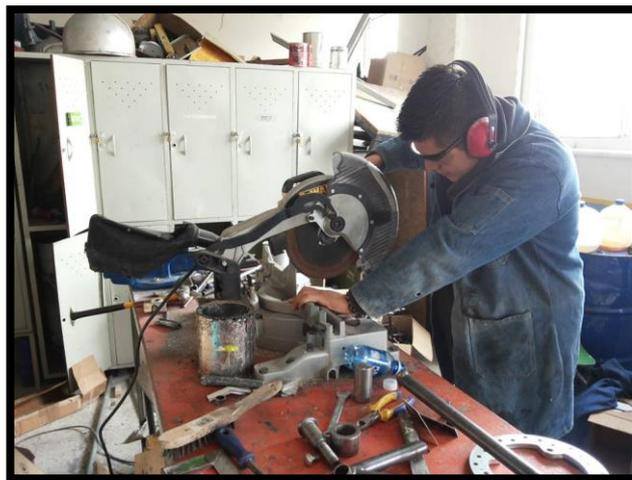
**Figura 4. 6.** Trozado y etiquetado de los tubos.
