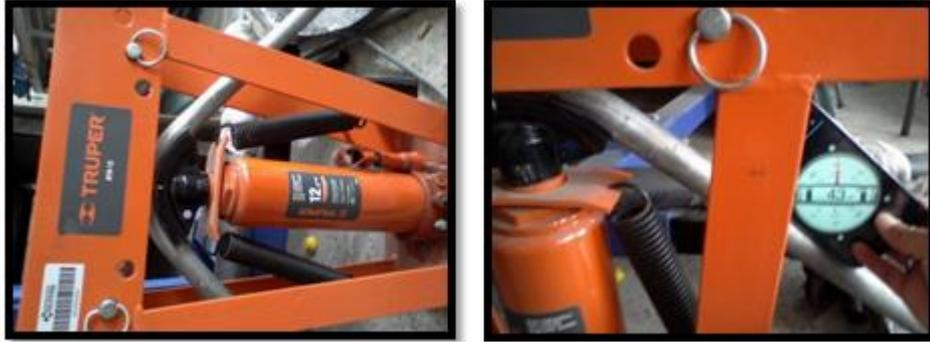
**Figura 4. 15.** Colocado de los tubos en la maquina dobladora
