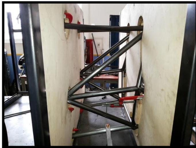
**Figura 4. 18.** Colocación de tubos mampara al arco frontal
