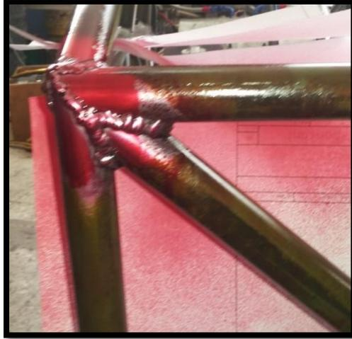
**Figura 4. 29.** Aplicación del líquido penetrante.
