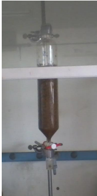
Figura 12. Maceración a temperatura ambiente de la muestra vegetal con disolventes de polaridad creciente (éter etílico, metanol y agua destilada).
