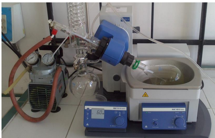
Figura 17. Concentración de los extractos a presión reducida mediante el rotavapor.
