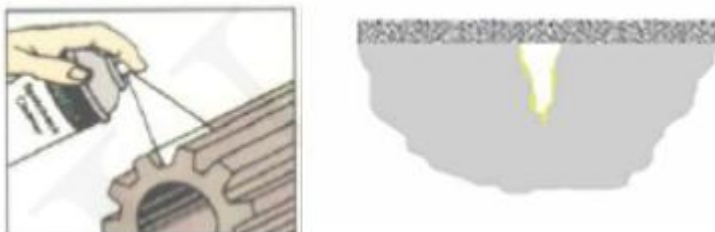
Figura 2. Limpieza, Tintas Penetrantes.
