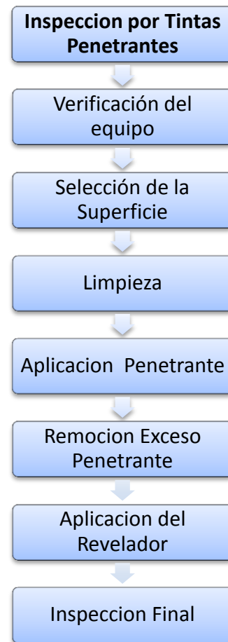
Figura 2. Proceso para inspección por tintas penetrantes.
