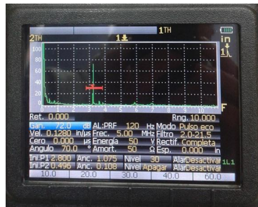
Figura 8. Máxima amplitud de la indicación (70°).
