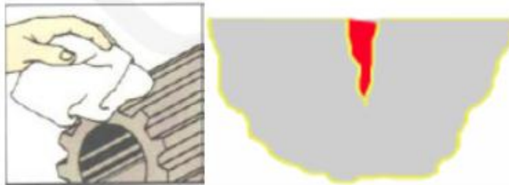
Figura 4. Remoción exceso, Tintas Penetrantes.
