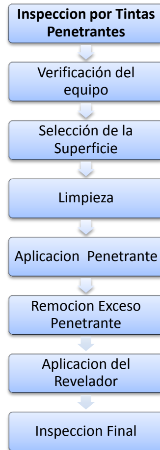
Figura 2. Proceso para inspección por tintas penetrantes.
