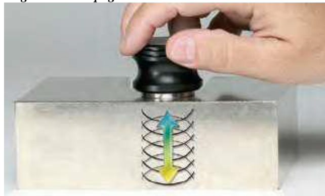
Figura 24. Propagación de la onda Ultrasónica.
