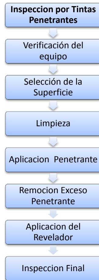
Figura 2. Proceso para inspección por tintas penetrantes.
