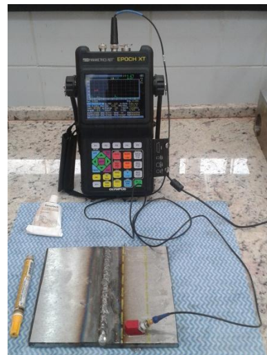
Figura 10. Inicio de la inspección.
