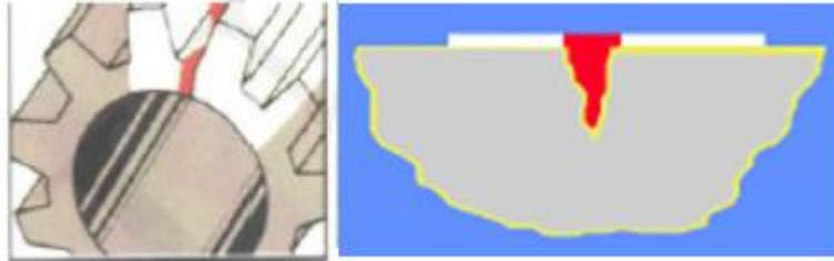
Figura 6. Inspección final, Tintas Penetrantes.
