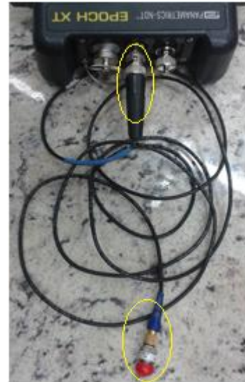
Figura 5. Conexión cable coaxial.
