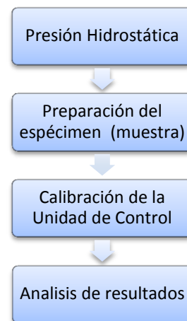
Figura 2. Proceso para inspección mediante Presión Hidrostática.
