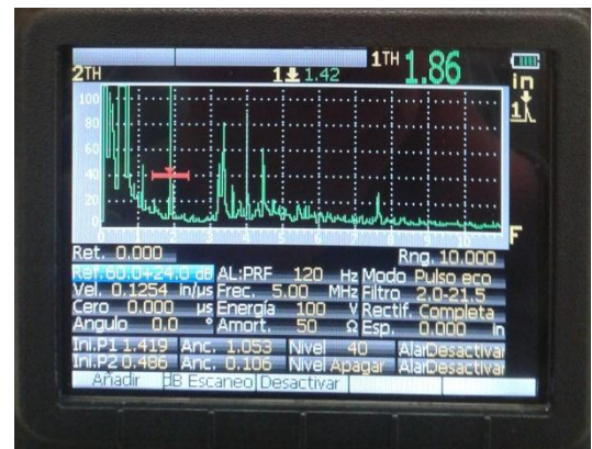
Figura 16. Eco generado por el barreno de 0.060".
