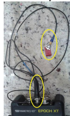
Figura 5. Conexión cable coaxial.
