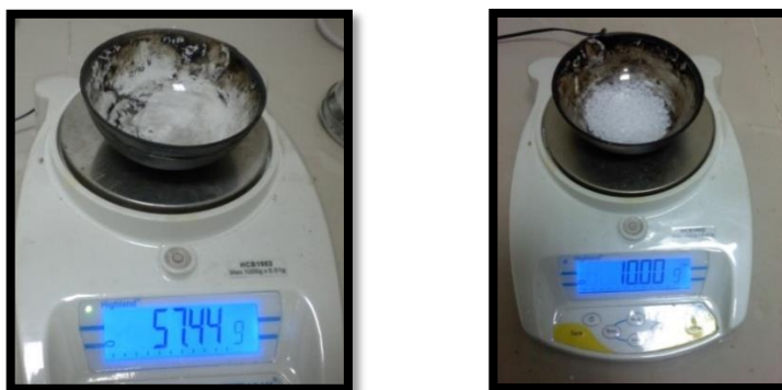
Ilustración 10.- Capsula de porcelana vacía y cápsula de porcelana con plástico
