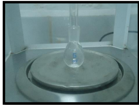
Ilustración 27.- Peso del picnómetro con agua
