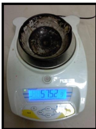
Ilustración 19.- Residuo sólido en cápsula de porcelana
