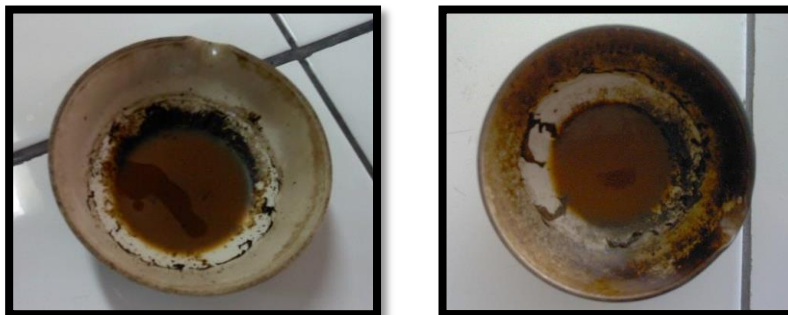
Ilustración 36.- Residuo resinoso acumulado en cápsula de porcelana
