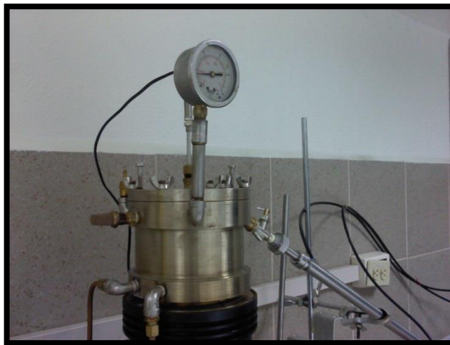
Ilustración 12.- Reactor de pirólisis completamente sellado
