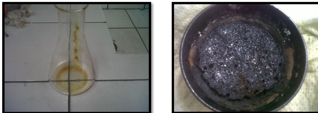
Ilustración 25.- Producto líquido y residuo carbonoso de PET
