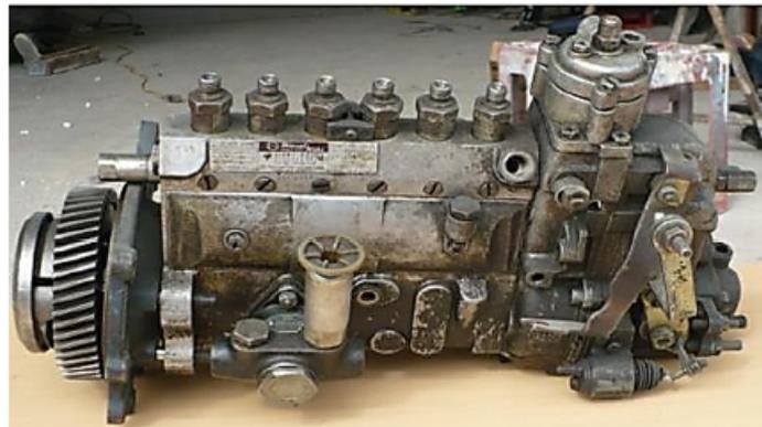
**Figura 1.10:** Bomba de inyección Diesel Kiki NP 684.
