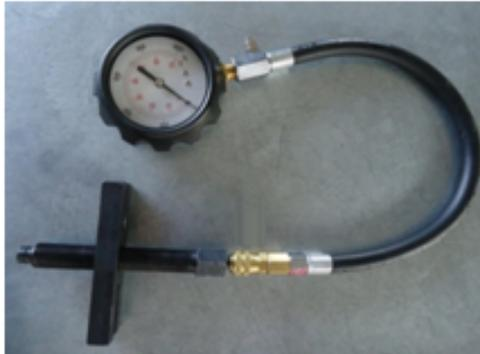
**Figura 2.15:** Medidor de compresión para motores diesel.
