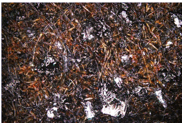
Figura 5.15: Repercusión del uso de un árbol de levas soldado sobre el papel filtrante del filtro de aceite.
