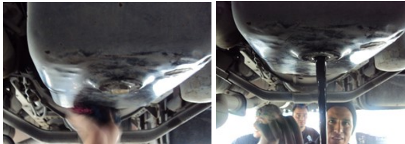
Figura 3.14: Drenado del aceite.
