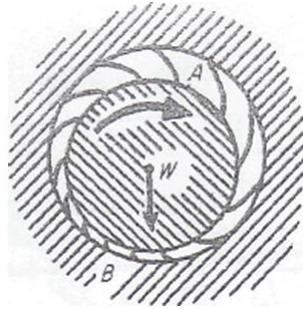
Figura 1.4: Rozamiento entre eje y cojinete.
