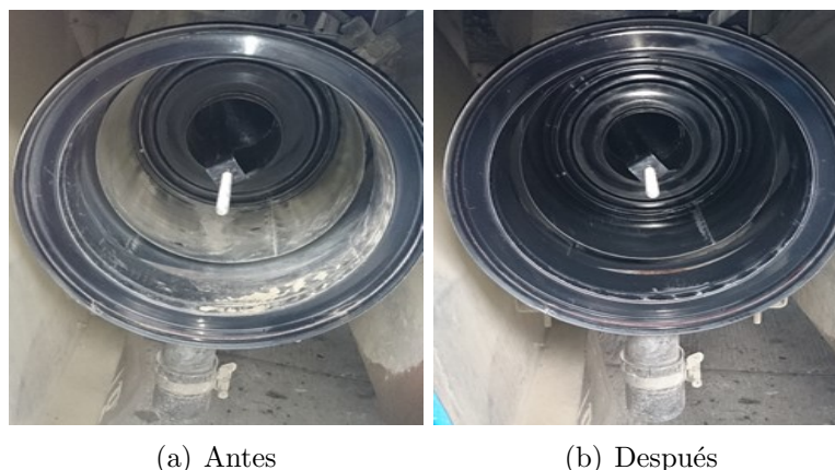
Figura 3.11: Limpieza del habitaculo del filtro de aire.
