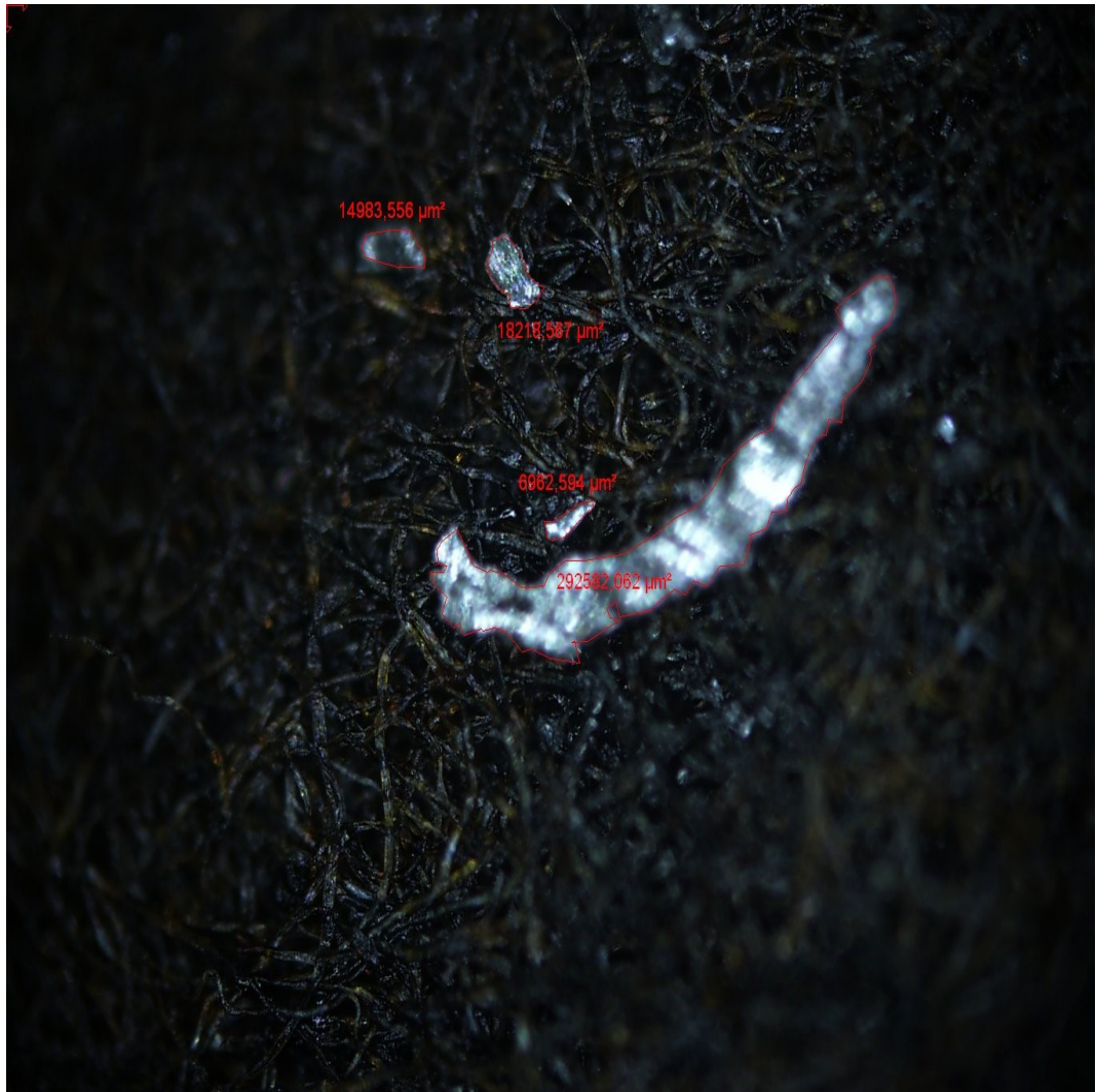
Figura A.11: Presencia de depositos metalicos y no metalicos sobre el papel filtrante de un filtro de aceite de baja gama usado.
