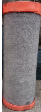
Figura 5.27: Filtro de aire interno de un motor diésel, después de un cierto recorrido.
