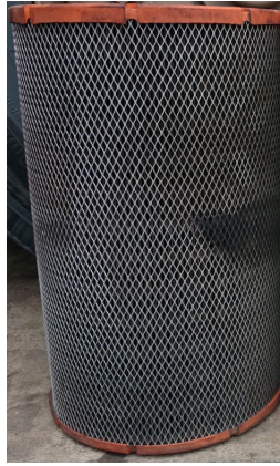
Figura 5.25: Filtro de aire externo de un motor diésel, después de un cierto recorrido.
