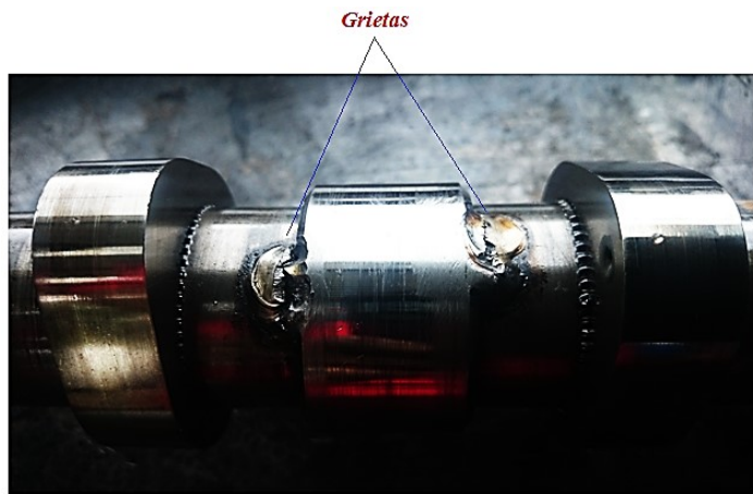
Figura 5.12: Grietas generadas sobre la soldadura del árbol de levas.
