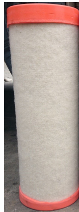
Figura 5.26: Filtro de aire interno de un motor diésel, nuevo.
