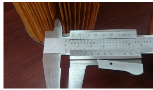
Figura 4.9: Medición de la distancia entre pliegues.
