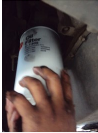
Figura 3.17: Montaje del filtro de aceite.
