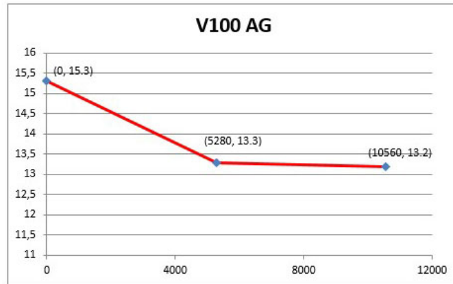
Figura 5.32: Comportamiento de la Viscosidad @100 utilizando un filtro de Alta Gama medida en Cst (centiStoke).
