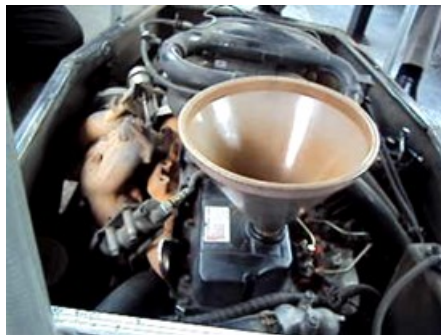
Figura 3.18: Proceso de llenado de aceite del motor.
