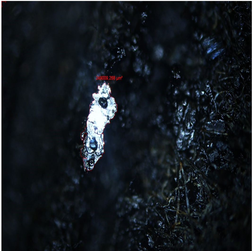
Figura A.15: Presencia de depositos metalicos y no metalicos sobre el papel filtrante de un filtro de aceite de alta gama usado.
