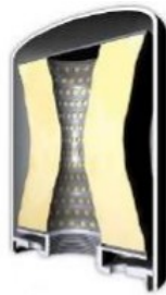
Figura 4.5: Colapso del tubo central por acción de una sobrepresión del sistema de lubricación.
