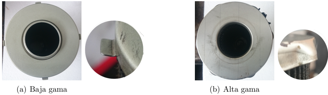
Figura 4.13: Diferencias entre las tapas superiores del elemento filtrante, lengüetas.
