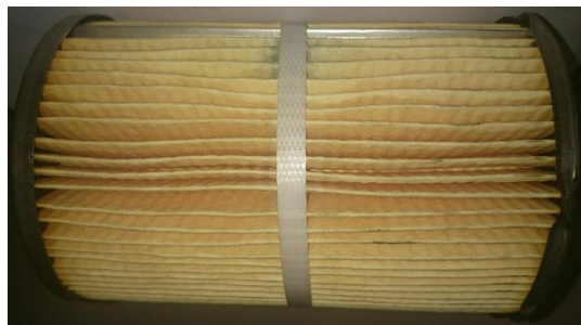
Figura 1.27: Elemento filtrante reforzado con faja. Fuente: Autores.
