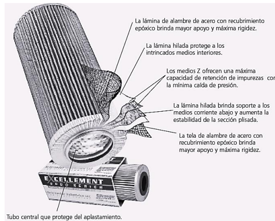
Figura 1.26: Estructura de un filtro de aceite sintético. Fuente: http: [24]
