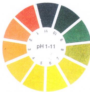
Figura 2.9: Patrón de colores para la comprobación de PH del aceite.
