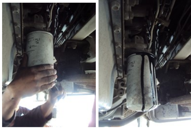
Figura 3.15: Desmontaje del filtro de aceite usado. Fuente: Autores
