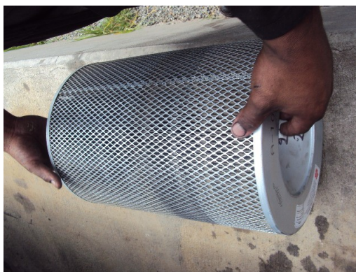
Figura 3.10: Proceso adecuado para eliminar el excedente de polvo de un filtro de aire.
