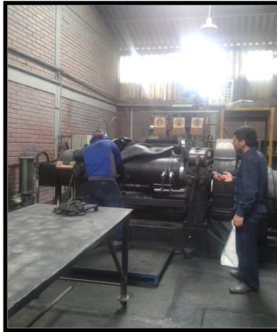
Ilustración 15: Medición de Riesgo Ruido en el Área de Molino Fuente: Los Autores
