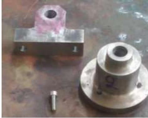
Figura 3.2.- Base del eje, manzana y perno.
