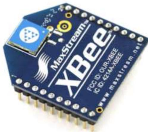
Figura 2.22.- Xbee con antena Chip
