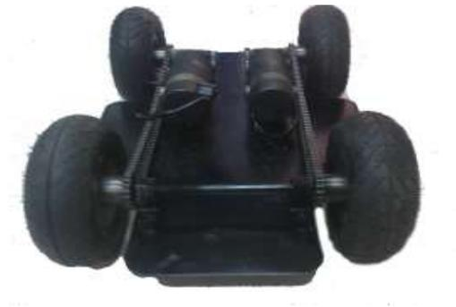
Figura 3.4.- Sistema de transmisión del robot.
