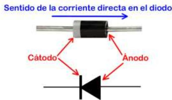
Figura 2.9.-Diodo rectificador.
