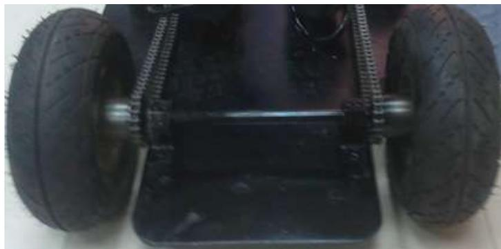
Figura 2.30.- Eje de transmisión de Tutuchin.
