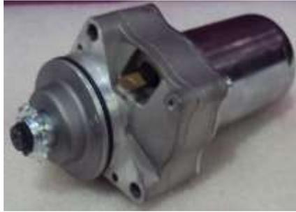
Figura 2.5.-Motor de arranque utilizado en Castigador.
