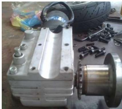
Figura 2.37 Motor con caja reductora sin fin.
