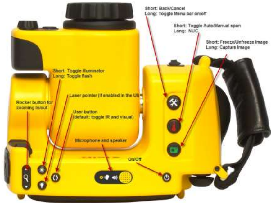
Vista lateral de la cámara Termo gráfica.
