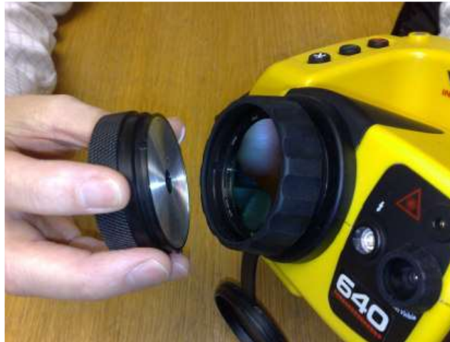
Instalación de Filtro.
