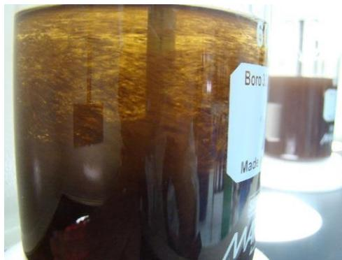
**Ilustración 20: Muestra de agua contaminada en el equipo de prueba de jarras, después de la dosificación de quitosano.**
