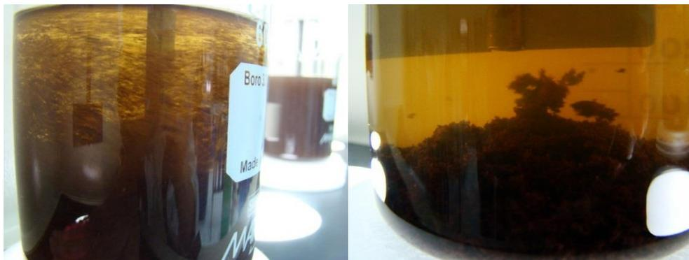
**Ilustración 3: Proceso de coagulación-floculación a escala laboratorio.**
