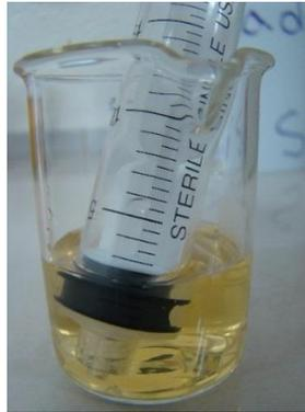
**Ilustración 19: Solución de quitosano y jeringuillas para dosificación.**
